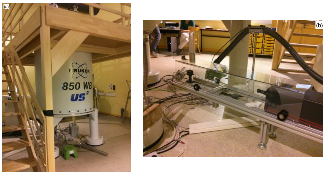
Figure 2.9 – Photographies (a) du spectromètre Bruker à très haut champ \mathbf{B}_0 = 19.9 T, 850 MHz et (b) du dispositif de chauffage laser.
