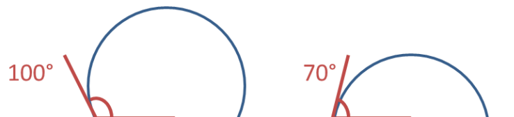
Figure 13 : Illustration de deux liquides en contact avec un support plat mais de tensions superficielles différentes.
