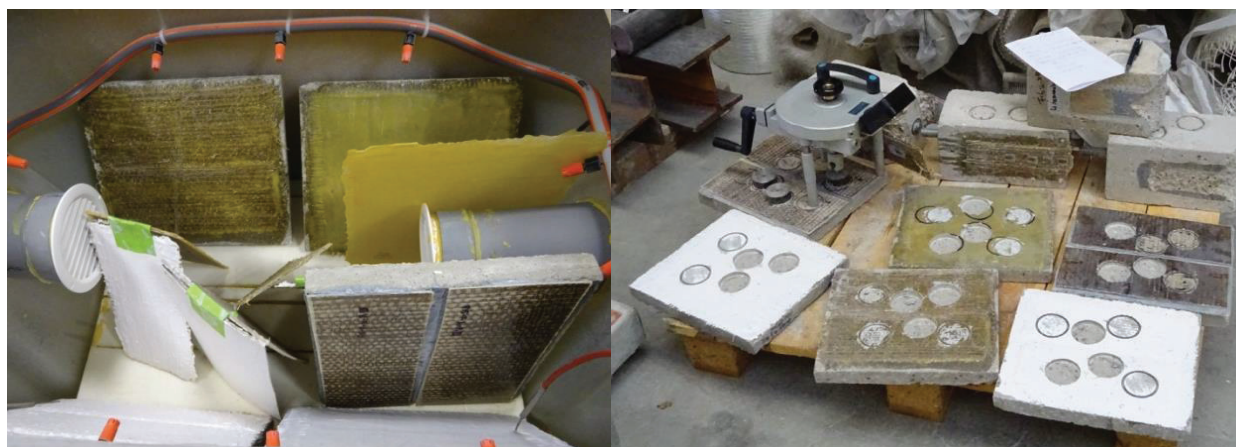
Figure 121 : A gauche, mise en place des dalles dans la chambre d'essai. A droite, caractérisation de l'adhérence par essai d'arrachage pull-out.
