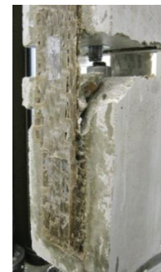
Figure 86 : Relation entre le mode de rupture et la répartition des déformations avant rupture.
