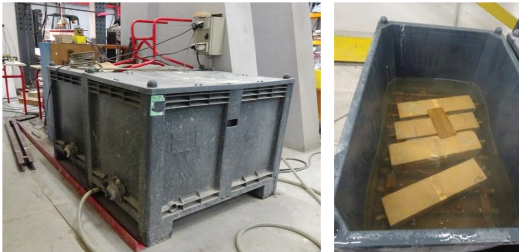
Figure 125 : Mise en place des éprouvettes de cisaillement dans la cuve à eau à 70°C.
