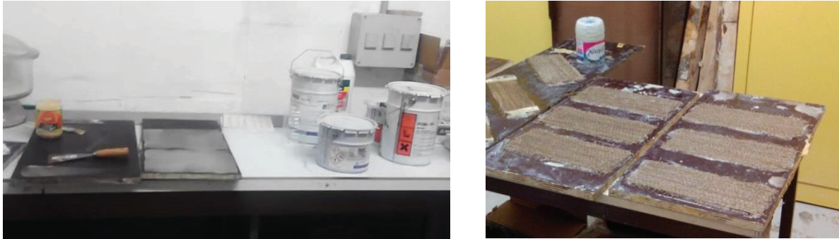
Figure 53 : Plaques de composite avec résines Eponal® 342 et Epx TFC ® et tissus Sergé 350 g/m 2 après marouflage.
