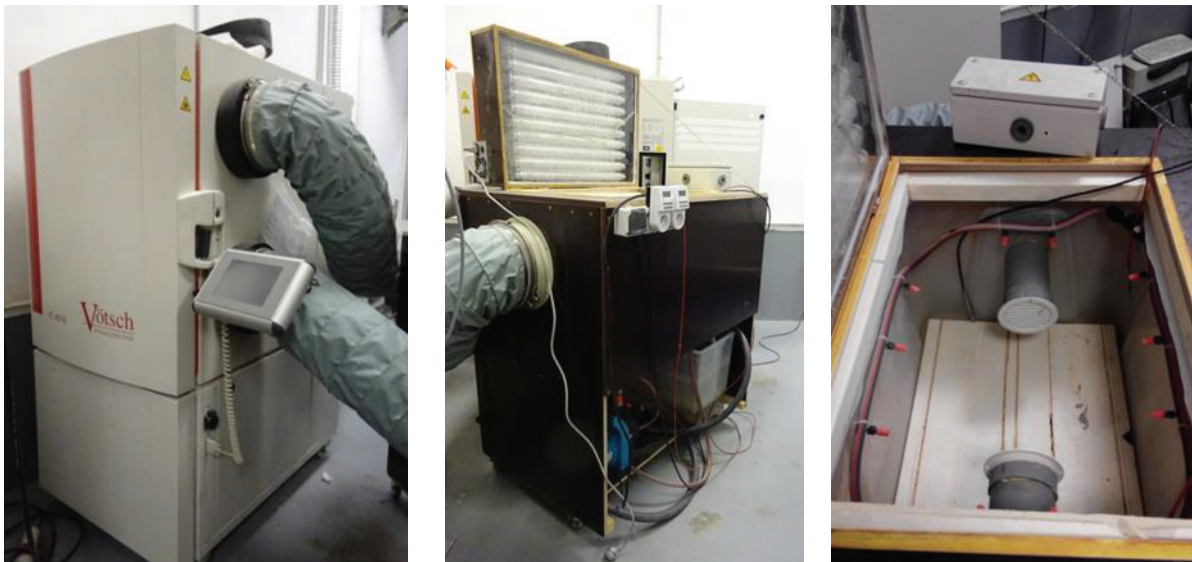
Figure 111 : A gauche, enceinte Voetsch VC4018. Au centre, chambre externalisée avec les lampes UV intégrées au volet et reliée à l'enceinte par des tuyaux isolés. A droite, intérieur de la chambre avec le système de pluie faisant le tour du bac et les entrée/sortie de l'air venant de l'enceinte.
