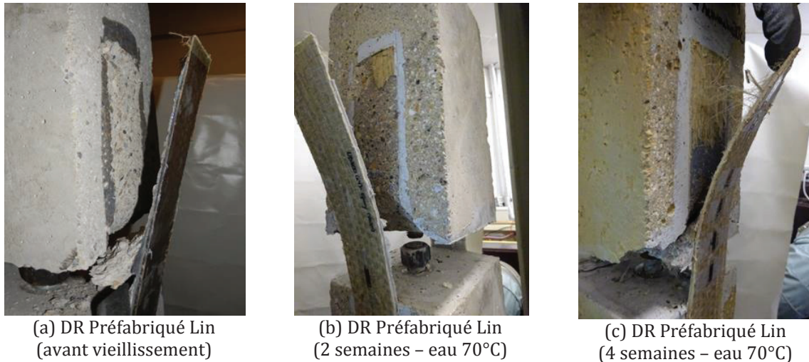
Figure 134 : Modes de ruptures des éprouvettes de cisaillement à double recouvrement renforcées par le composite lin préfabriqué après 0-2-4 semaines de vieillissement hygrothermique à 70°C.
