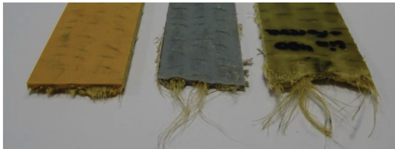
Figure 39 : Eprouvettes de traction des composites de lin UD 400 g/m 2 (2009) avec les résines de gauche à droite Ostral 800, Sikadur 330 et Foreva TFC. Les fibres de lin sont sèches à cœur.
