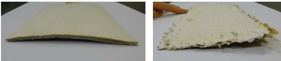
Figure 115 : Déformation des plaques composites à renfort de fibres de lin et revêtues d'un gel coat.
