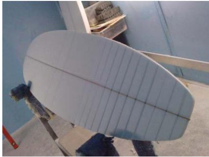
(c) Mousse de polystyrène en train d'être façonnée pour fabriquer un surf (Fatlines Surfboards).
