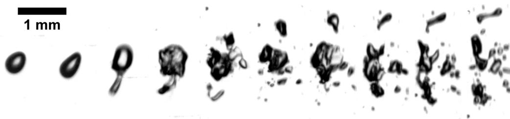
**Figure 4.26** – Fragmentation d’une bulle lors de son entrée dans une constriction. Intervalle de temps entre chaque image  $\Delta t = 125 \mu s$ .
