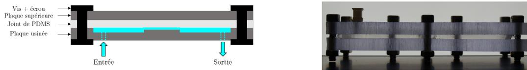
Figure 2.5 – Schéma en coupe et image d'une puce millifluidique assemblée.
