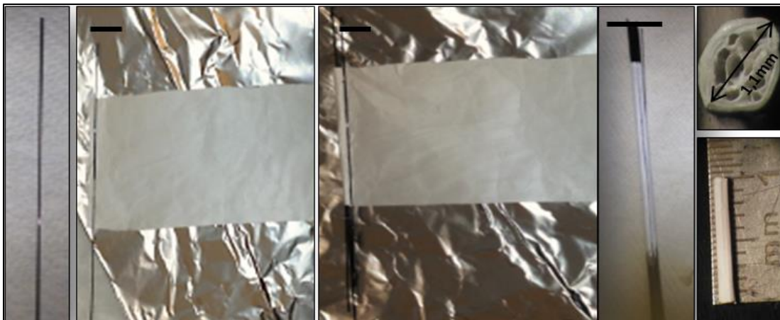
Figure 18 : Fabrication 3D du conduit nerveux à base de nanofibres de soie alignées
