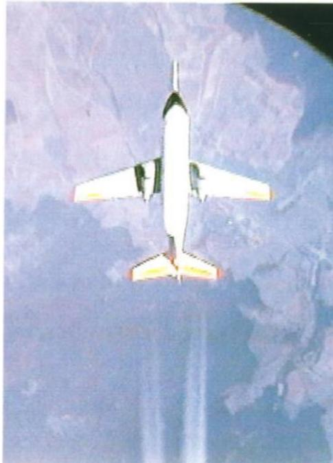
Figure 71 : Photographie des traînées de condensation issues de l'avion ATTAS à une distance de 50 m vues du dessus. Les moteurs consomment des carburants avec différentes teneurs en soufre (170 ppm à gauche, 5500 ppm à droite).
