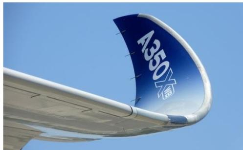
Figure 12 : Winglet au bout d'une aile d'un A350
