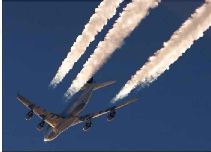
Figure 21 : Traînées de condensation formées dans le sillage d'un B747 en vol de croisière.
