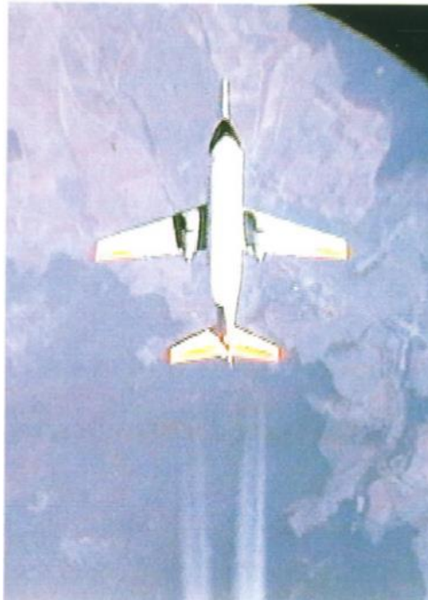
Figure 92 : Photographie des traînées de condensation issues de l'avion ATTAS à une distance de 50 m vues du dessus. Les moteurs consomment des carburants avec différentes teneurs en soufre (170 ppm à gauche, 5500 ppm à droite).
