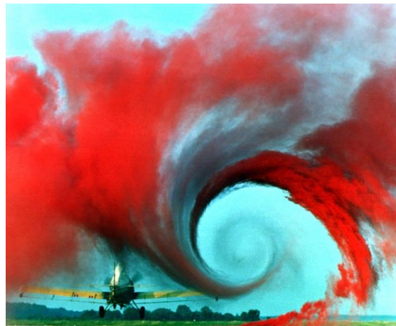
Figure 11 : Visualisation d'un tourbillon de sillage créée par le passage d'un avion léger à travers un panache de fumée rouge
