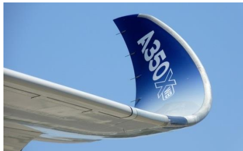
Figure 12 : Winglet au bout d'une aile d'un A350
