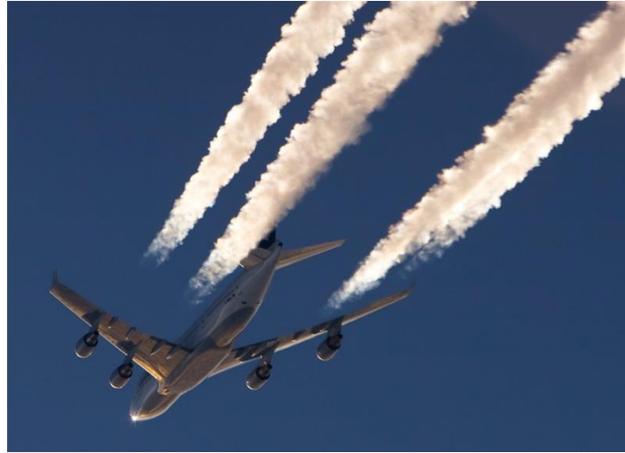
Figure 21 : Traînées de condensation formées dans le sillage d'un B747 en vol de croisière.
