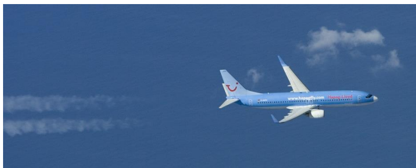
Figure 74 : Photographie de la formation d'une traînée de condensation dans le panache d'un Boeing B737.
