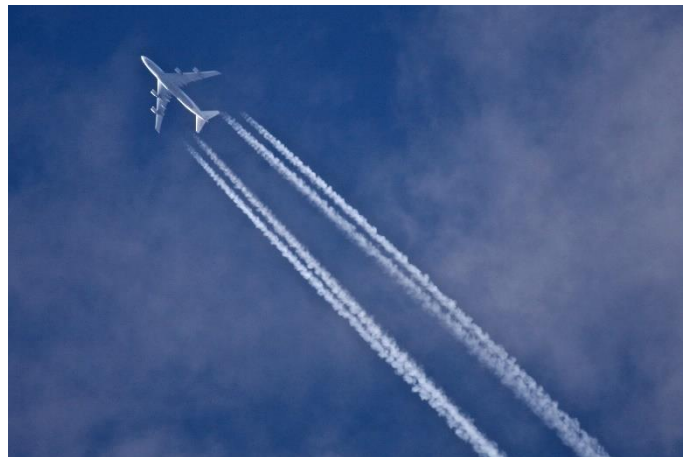
Figure 1 : Photographie d'une traînée de condensation laissée dans le sillage d'un avion de ligne à réaction.
