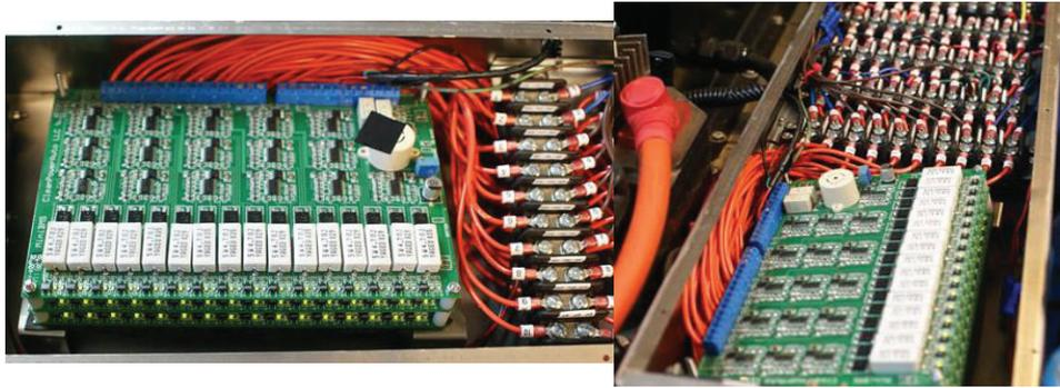
Figure 1.28 BMS centralisé
