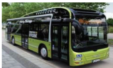
Man Lyon's City hybride (Le module de supercondensateurs assure le démarrage en tout électrique)
