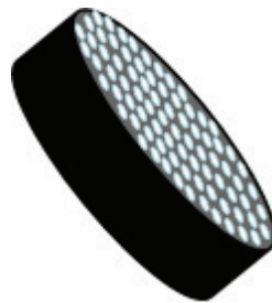
Figure 1.10 Représentation des pores dans l'électrode en charbon actif dans l'hypothèse du modèle simple pore
