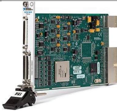
Figure. Annexe A.2. Présentation du module NI PXI-7841
