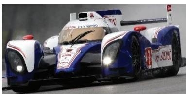
Toyota TS030 hybride (Le module de supercondensateurs récupère l'énergie de freinage et booste l'accélération)
