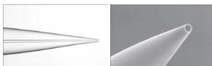
Figure 18 : Photographie d'un capillaire nanoESI (SillicapTip™, New Objective).
