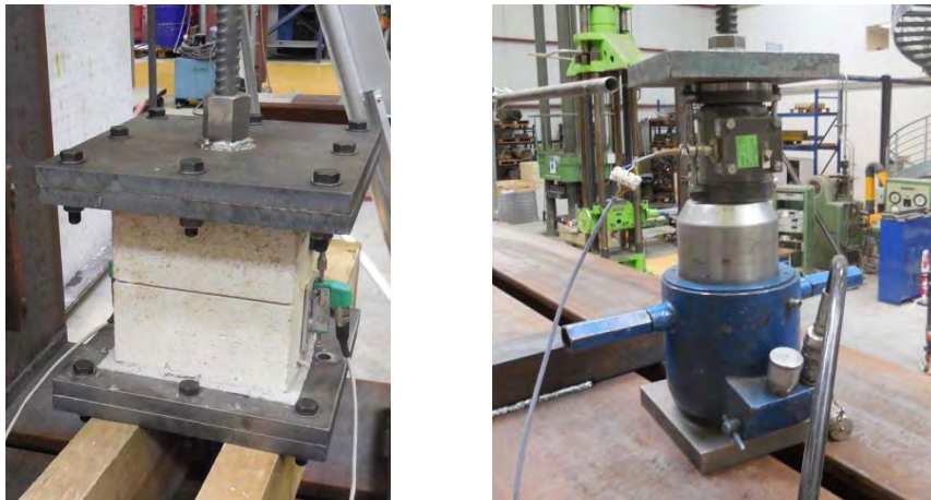
Figure III.1-16 : Dispositif d'essai de traction des blocs calcaires. (a) Éprouvettes équipées de capteurs de déplacements. (b) Vérin et Dynamomètre.
