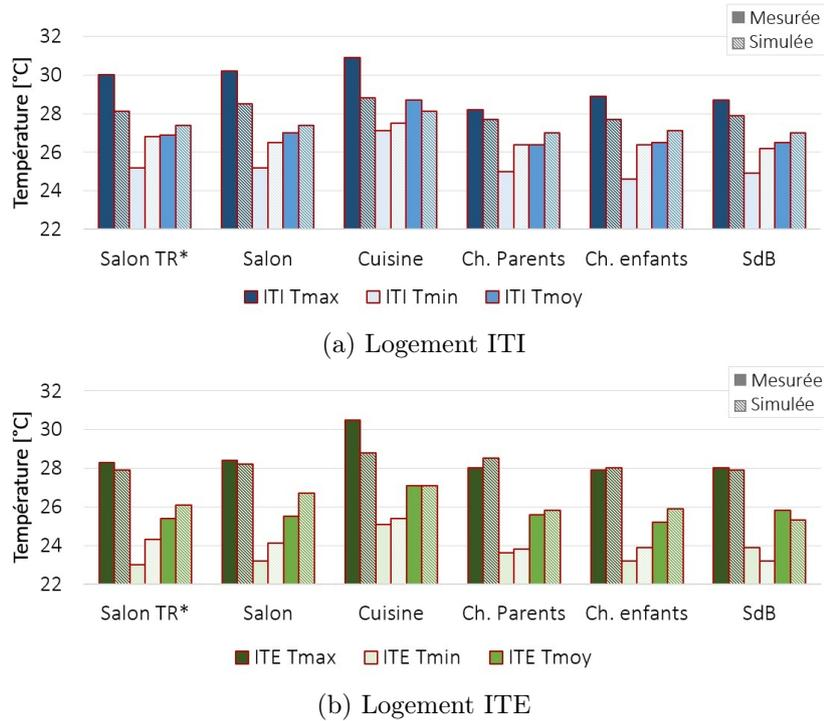
FIGURE 5.18 – Valeurs de température maximales (Tmax), minimales (Tmin) et moyennes (Tmoy) obtenues par simulation et par mesure. Validation du modèle
