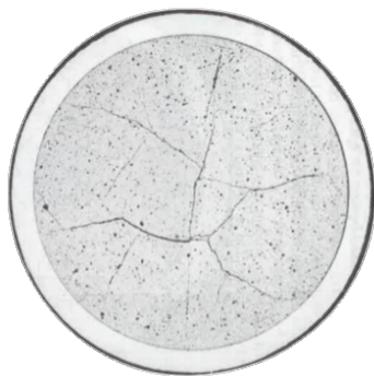
FIGURE 1.6 – Macrographie d'une pastille REP fissurée par le gradient thermique
