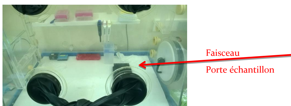
Figure 2 : Montage expérimental (boîte à gants) pour l'analyse en UV-visible
