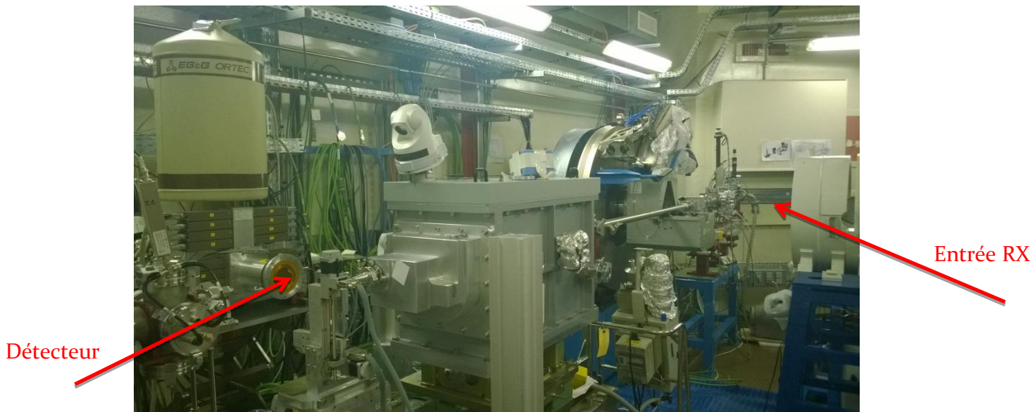
Figure 20 : cabine de mesure de la ligne MARS de SOLEIL
