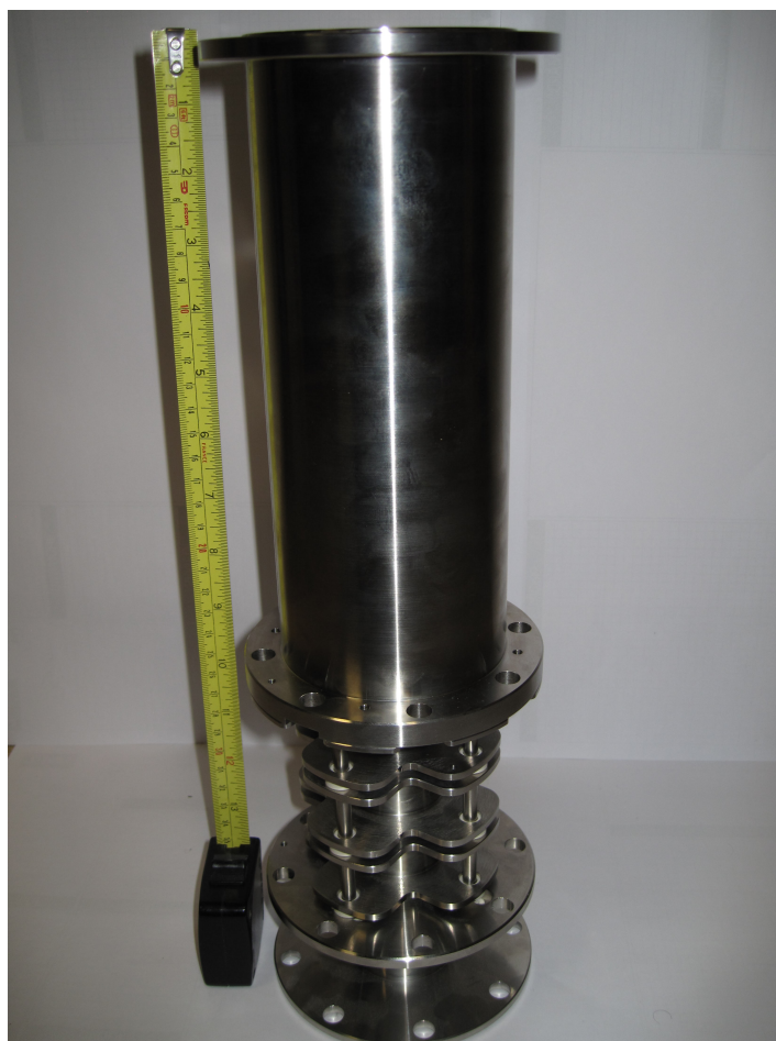
FIGURE 5.23 – Photographie du montage d’une partie de la colonne composée des 2 blindages et de la lentille électrostatique. Ces pièces ont été dessinées et usinées au laboratoire Aimé-Cotton.
