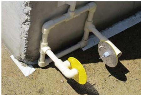
Figure 37 – Capteur de foisonnement de la mousse par mesure de conductimétrie
