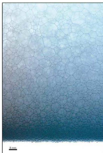
Figure 8 – Mousse après vieillissement : sèche en haut et humide en bas, extrait de [11].
