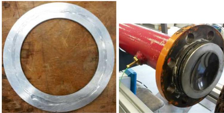
Figure 27 – Membrane de séparation : sur son support aluminium (à gauche) et mise en place sur le tube (à droite)
