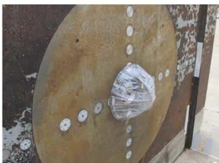
Figure 38 – Structure d'exclusion de la mousse
