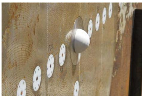
Figure 40 – Charge explosive hémisphérique de 70 g collée sur la table de mesure.
