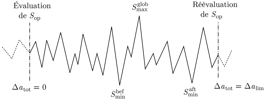
Figure 6.21 – Définition des chargements S_{\text{min}}^{\text{bef}} , S_{\text{max}}^{\text{glob}} et S_{\text{min}}^{\text{aft}} (Dominguez, 1994).
