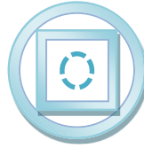
Figure 25 : Centrage parfait du capillaire de section carrée dans le capillaire cylindrique. Le cercle en pointillés représente la buse obtenue après étirement du capillaire interne de section carrée.
