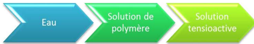
Figure 6 : Représentation des trois étapes successives d'injection du procédé EOR.
