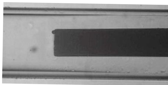
Figure 33: Capillaire interne centré dans le capillaire externe.
