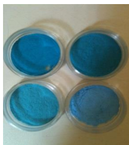
Figure 18 : Poudres obtenues pour la synthèse des compositions \text{LiCuPO}_4 , \text{Li}_2\text{CuP}_2\text{O}_7 , \text{LiCu}_2\text{P}_3\text{O}_{10} , \text{LiCu}_3\text{P}_3\text{O}_{11}
