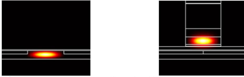
Figure II-18 Simulation du mode hybride couplé entre le guide silicium rib et la structure active MQW, pour un mode confiné dans un guide purement Si (à gauche), et pour un mode confiné dans un guide hybride III-V sans ruban silicium (à droite).
