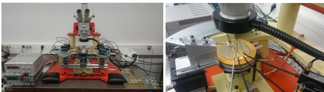
Figure II-55 Vue large à gauche (a) et rapprochée à droite (b) de la plateforme de caractérisation sous pointes (prober) avec couplage verticale pour les composants sur plaque.
