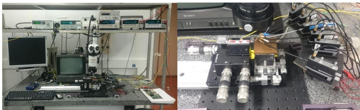
Figure III-10 Vue large (a) et rapprochée (b) du banc de mesure dédié aux composants photoniques sur silicium hybrides actifs.
