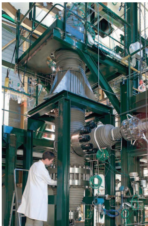
Figure 42. Photographie du réacteur LFHT (sans son calorifugeage)
