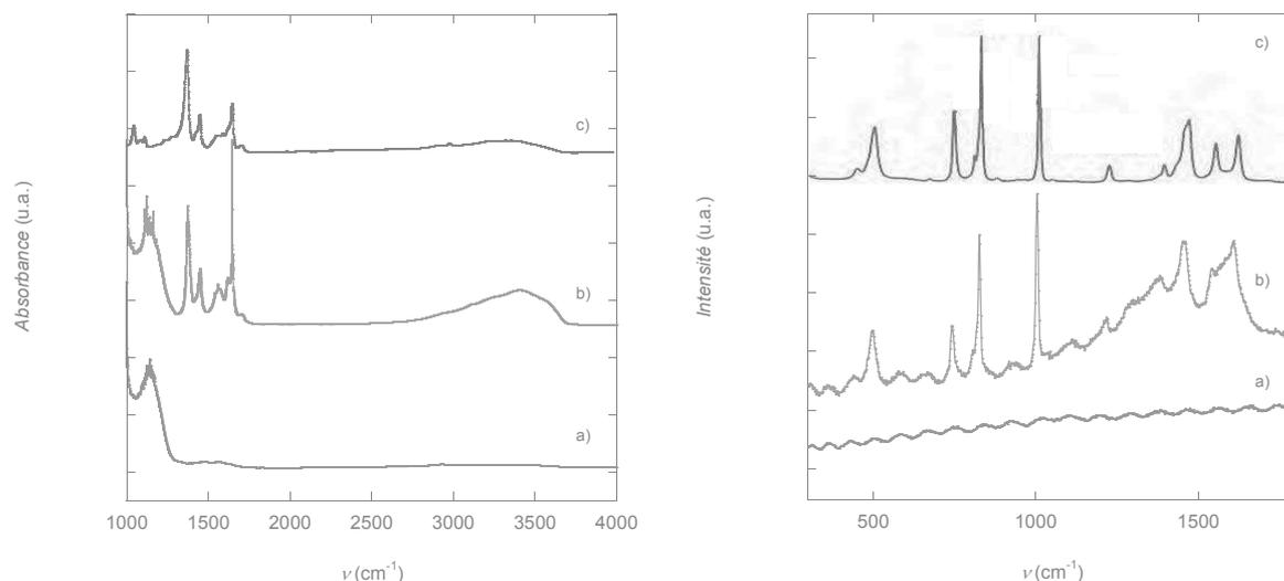
**Figure 2.12.** A gauche : Spectres infrarouge d'une Membrane  $-NH_2$  pour  $n = 0$  cycles (a),  $n = 20$  cycles (b), et de la poudre HKUST-1 obtenue par synthèse solvothermale (c). A droite : Spectres Raman d'une membrane  $-NH_2$  pour  $n = 0$  cycles (a),  $n = 20$  cycles (b), et de la poudre HKUST-1 selon les travaux de Prestipino *et al.* (c).<sup>31</sup>
