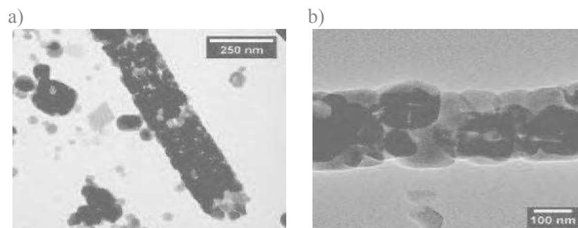
**Figure 3.28.** Clichés MET montrant l'assemblage des cristaux des nanostructures de ZIF-8.
