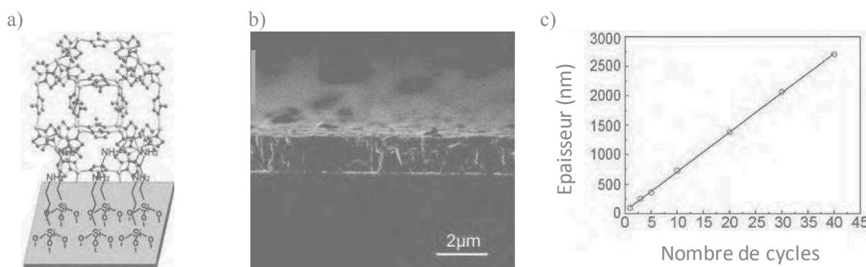
**Figure 3.8.** Fabrication de films de ZIF-8 à la surface des électrodes (a), Epaisseur de film pour 20 cycles d'immersion (b) et graphe représentant l'épaisseur du film de ZIF-8 en fonction du nombre de cycle appliqué (c).<sup>27</sup>
