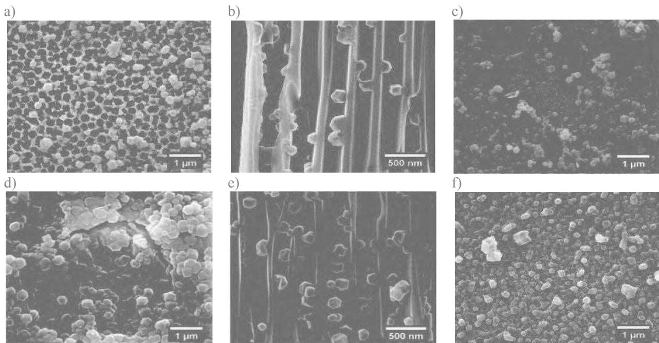
**Figure 3.18.** Clichés MEB d'une membrane -  $\text{NH}_2$  avec  $n = 3$  cycles (haut) et  $n = 6$  cycles (bas), pour un ratio 1 :4 et une concentration en  $\text{Zn}(\text{NO}_3)_2$  égale à 100 mM. Vue surfacique de la face A (a), vue transversale (région centrale de la membrane) (b) et vue surfacique de la face B (c).
