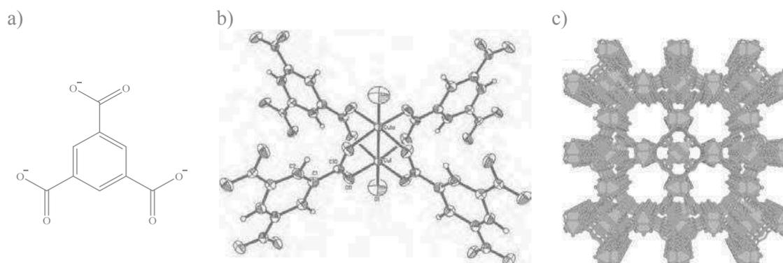
**Figure 2.9.** Ligand  $\text{BTC}^{3-}$ , espaceur organique utilisée dans le polymère de coordination poreux HKUST-1 (a), motif « roue à aube » résultant de l'association de deux ions  $\text{Cu}(\text{II})$  avec quatre ligands  $\text{BTC}^{3-}$  (la sphère de coordination de chaque  $\text{Cu}(\text{II})$  est complétée par une molécule de  $\text{H}_2\text{O}$ ) (b) et structure de HKUST-1 (c).<sup>21</sup>
