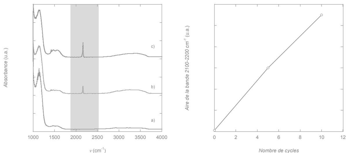
**Figure 4.15.** A gauche : Spectres infrarouge d'une membrane -  $\text{NH}_2$  pour  $n = 0$  cycles (a),  $n = 5$  cycles (b),  $n = 10$  cycles (c). La bande caractéristique des groupements cyano est surlignée en bleu, celle-ci nous sert de référence pour intégrer l'aire sous la courbe entre 2000-2500  $\text{cm}^{-1}$  (à droite).
