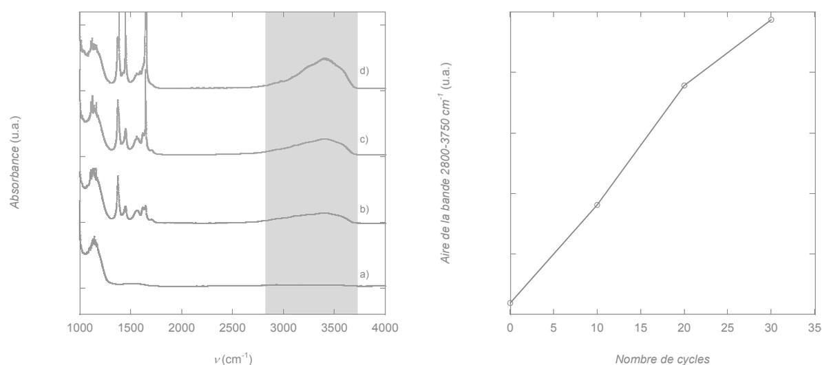
**Figure 2.16.** A gauche : Spectres infrarouge d'une membrane –  $\text{NH}_2$  pour  $n = 0$  cycles (a),  $n = 10$  cycles (b),  $n = 20$  cycles (c),  $n = 30$  cycles (d) La bande caractéristique de l'eau est surlignée en bleu, celle-ci nous sert de référence pour intégrer l'aire sous la courbe entre  $2800\text{-}3750\text{ cm}^{-1}$  (à droite)
