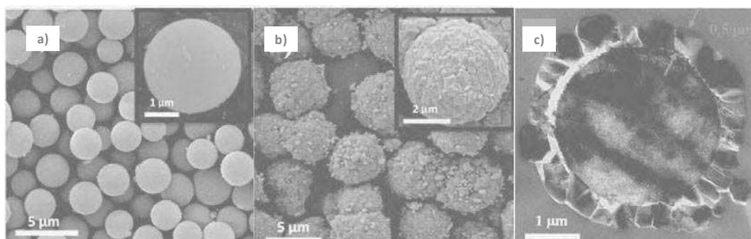
**Figure 1.10.** Clichés MEB surfacique des billes de silices mésoporeuses (a) et des composites ZIF-8/billes de silice (b), coupe transversale d'une bille composite (c).<sup>43</sup>
