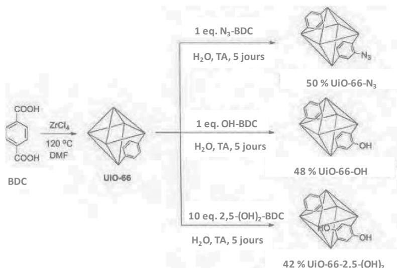
**Figure 1.6.** Echange post-synthétique de ligand dans le MOF UiO-66 par des ligands à motif azido, hydroxyl ou dihydroxyl.<sup>26</sup>
