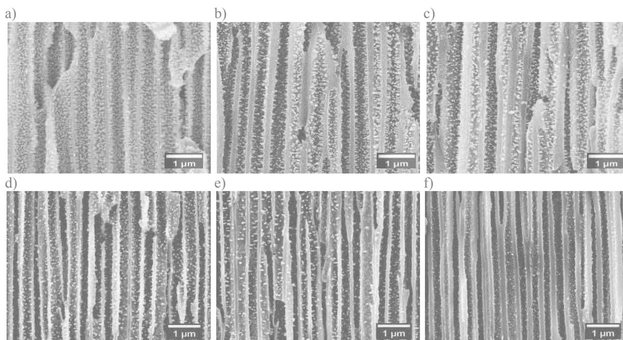
**Figure 2.27.** Clichés MEB pour la tranche d'une membrane et d'une membrane fonctionnalisée avec  $n = 3$  cycles : (a et d) à proximité de la face A, (b et e) région centrale, et (c et f) à proximité de la face B.
