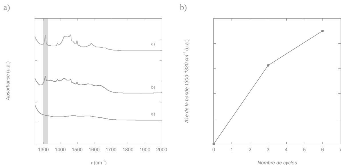
**Figure 3.17.** A gauche : Spectres infrarouge d'une Membrane –  $\text{NH}_2$  pour  $n = 0$  cycles (a),  $n = 3$  cycles (b),  $n = 6$  cycles (c), pour un ratio 1 :4 et une concentration en  $\text{Zn}(\text{NO}_3)_2$  égale à 100 mM. La bande caractéristique du cycle imidazole est surlignée en bleu, celle-ci nous servant de référence pour intégrer l'aire sous la courbe entre 1300-1330  $\text{cm}^{-1}$  (à droite).
