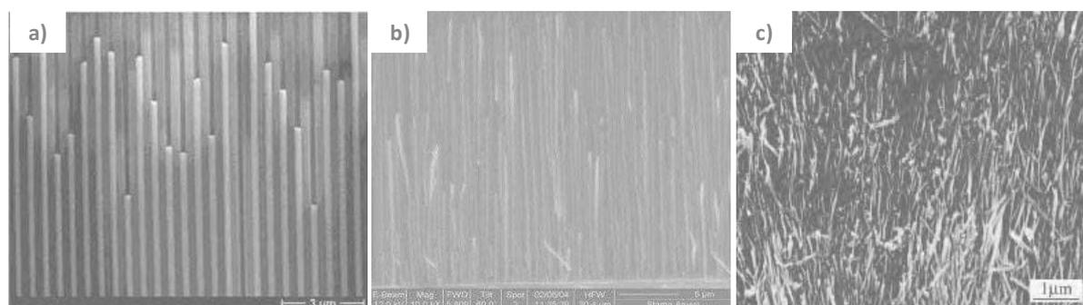
**Figure 1.30.** Clichés MEB de nanofils d'argent dans la matrice d'alumine (a), de nanofils de cobalt (b) et d'antimoine (c) après dissolution de l'alumine.<sup>97, 101, 102</sup>
