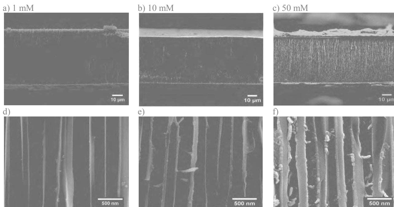
**Figure 4.14.** Clichés MEB pour la tranche d'une membrane -  $\text{NH}_2$  avec  $n = 5$  cycles et une concentration en précurseurs de 1 mM (a), 10 mM (b) et 50 mM (c). Les images (d-f) correspondent à des zooms (région centrale) des images montrées dans (a-c).
