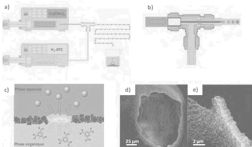
**Figure 1.11.** Dispositif expérimental permettant l'élaboration des capsules de HKUST-1 (a-b), les nanocristaux sont formés à l'interphase entre la solution aqueuse d'acétate de cuivre et la solution de ligand organique  $H_3$ -BTC (c), Clichés MEB d'une capsule percée à l'aide d'une aiguille pour observer sa macrocavité (d) et coupe transversale de la paroi d'une capsule constituée de nanocristaux de MOF (e).<sup>45</sup>
