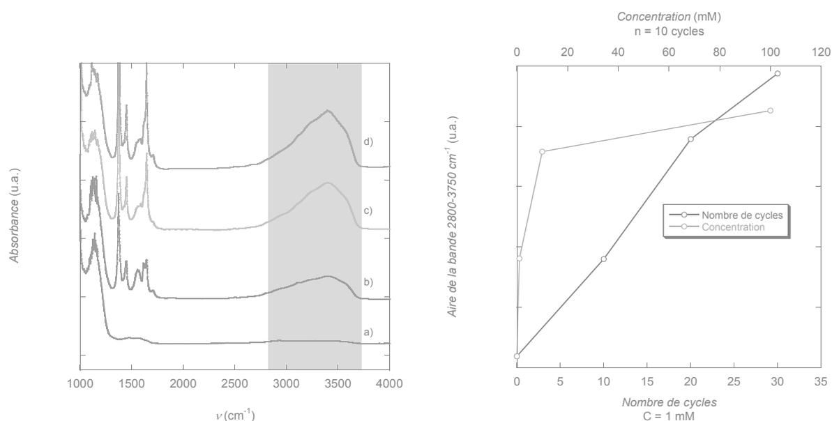
**Figure 2.21.** A gauche : Spectres infrarouge d'une membrane – NH<sub>2</sub> (a), pour  $n = 10$  cycles et  $C = 1$  mM (b),  $C = 10$  mM (c),  $C = 100$  mM (d). A droite : évolution de l'aire de la bande d'eau en fonction du nombre de cycle appliqué, pour une concentration fixée à 1 mM (courbe noire), et en fonction de la concentration initiale en réactifs, pour  $n = 10$  cycles (courbe rouge).
