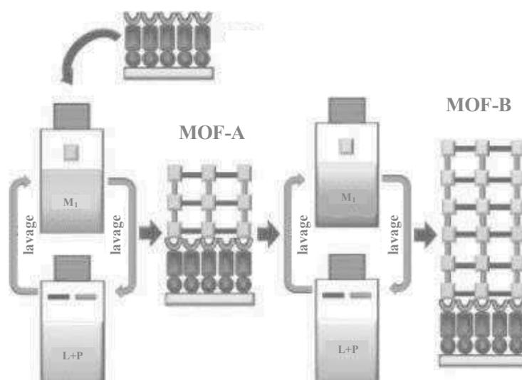
**Figure 1.13.** La méthode couche par couche pour la croissance de films de MOFs sur des surfaces. M<sub>1</sub> est le précurseur métallique et L+P sont les deux ligands organiques impliqués dans la construction de  $[\text{Zn}_2(1,4\text{-ndc})_2(\text{dabco})]$ .<sup>52</sup>
