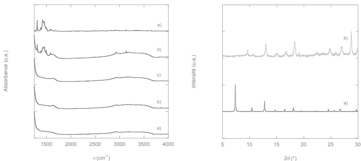
**Figure 3.9.** A gauche : Evolution du spectre infrarouge en fonction du nombre de cycle à 4 étapes appliqués sur une membrane  $-\text{NH}_2$  (a), 5 cycles (b), 10 cycles (c), 15 cycles (d), ZIF-8 (e). A droite : Diffractogrammes RX poudre pour ZIF-8 (simulé à partir de la structure RX) (a), pour une membrane  $-\text{NH}_2$  composite avec  $n = 6$  cycles obtenues en faisant varier le ratio métal : ligand, (b) 1 : 2.
