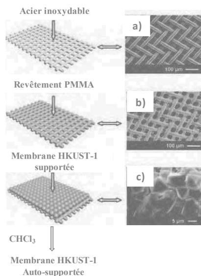
**Figure 1.15** Schéma illustrant la procédure de préparation des membranes auto-supportées de HKUST-1.<sup>61</sup>
