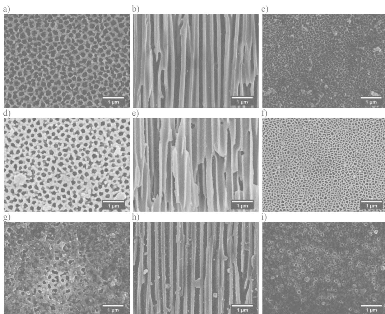
**Figure 2.17.** Clichés MEB d'une membrane  $-\text{NH}_2$  avec  $n = 10$  cycles (a-c), avec  $n = 20$  cycles (d-f) et avec  $n = 30$  cycles (g-i). Vue surfacique de la face A (a), vue transversale (région centrale de la membrane) (b) et vue surfacique de la face B (c)
