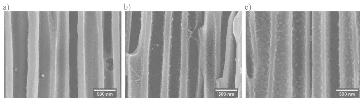
**Figure 2.22.** Clichés MEB de la tranche (région centrale) d'une membrane – NH<sub>2</sub> avec n=10 cycles, 1mM (a), 10 mM (b) et 100 mM (c).
