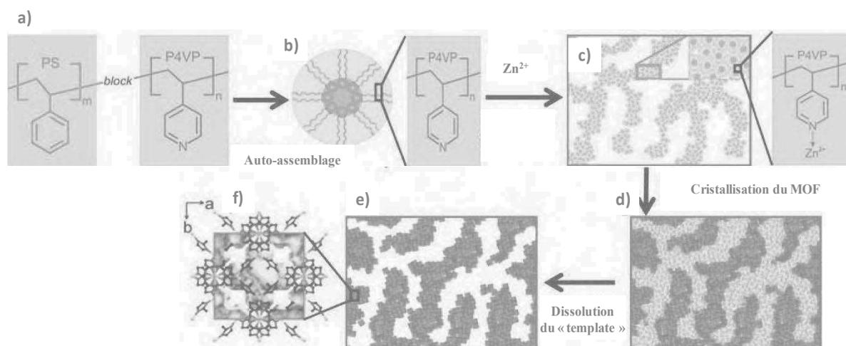
**Figure 1.16.** Représentation schématique de la synthèse des architectures 3D de ZIF-8 structurée dans des micelles de co-oligomère bloc.<sup>62</sup>
