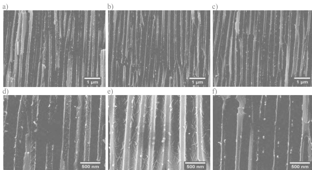
**Figure A2.2.** Clichés MEB pour la tranche d'une membrane  $-\text{NH}_2$   $n = 3$  cycles : (a) à proximité de la face A, (b) région centrale, et (c) à proximité de la face B. Les images (d-f) correspondent à des zooms des régions montrées dans (a-c).
