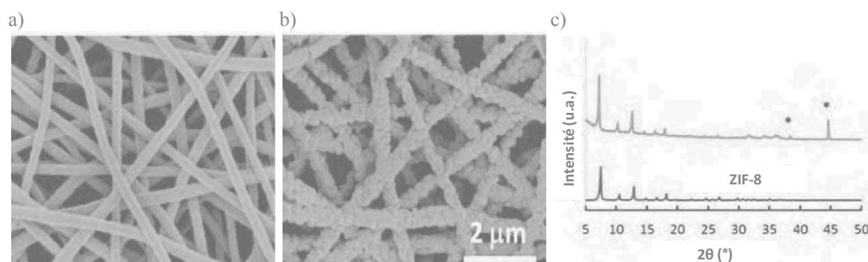
**Figure 3.6.** Clichés MEB des nanofibres de PAN : après dépôt de la couche d'oxyde de zinc (a), composites PAN/ZnO/ZIF-8 (b) et diffractogrammes des composites obtenus montrant la présence de ZnO et de ZIF-8, les pics marqués de (\*) sont imputables au support utilisé pour la mesure.<sup>21</sup>
