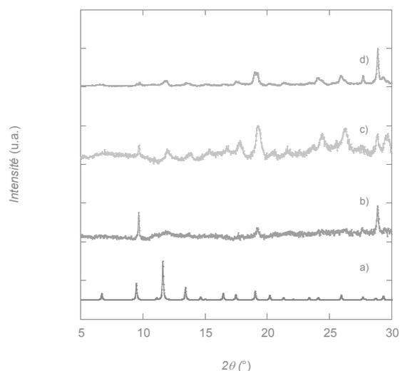
**Figure 2.23.** Diffractogrammes RX poudre pour HKUST-1 (calculé à partir de la structure RX) (a), pour une membrane – NH<sub>2</sub> n = 10 Cycles, 1 mM (b), 10 mM (c), 100 mM (d).
