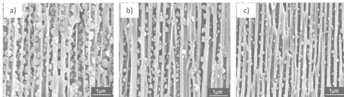
**Figure 1.20** Clichés MEB de vues transversales de la membrane composite HKUST-1/membrane d'alumine après 2 cycles de filtration (2h) de  $[\text{Cu}(\text{OAc})_2]_2$  et  $\text{BTC-H}_3$ , a) vue proche de la face d'entrée de la membrane, b)vue centrale et c)vue proche de la face de sortie de la membrane.<sup>74</sup>
