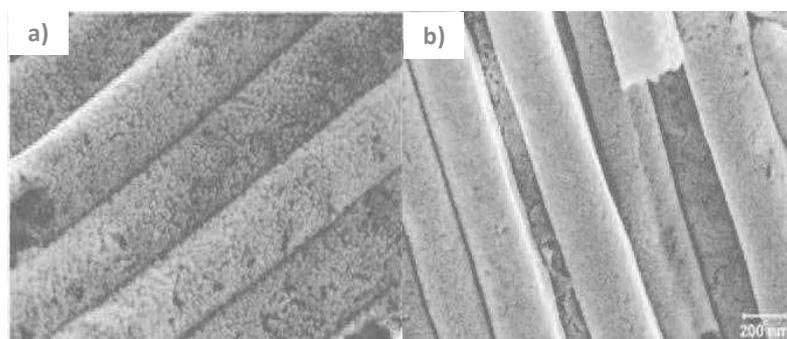
**Figure 1.33.** Clichés MEB pour les nanotubes Au (a) et pour les nanotubes Au-Pd (b).<sup>104</sup>
