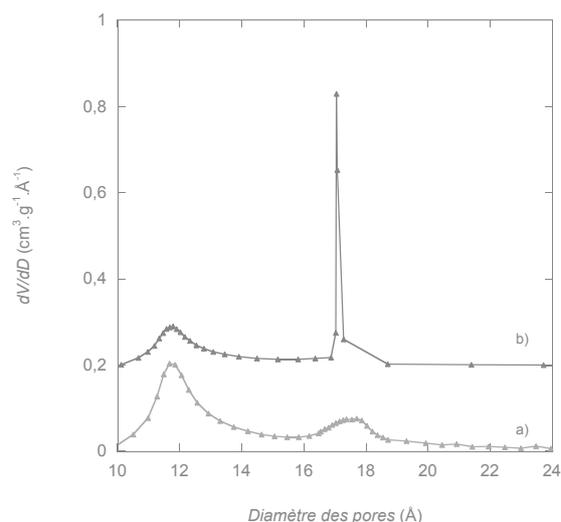
**Figure 3.21.** Distribution de la taille des pores calculée par la méthode Horvath-Kawazoe (HK) en considérant des pores de forme cylindrique pour la membrane –  $\text{NH}_2$  composite avec  $n = 6$  cycles (a) et pour la poudre de ZIF-8 synthétisée à température ambiante.
