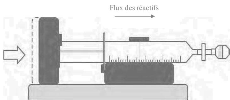
Figure 2.10. Représentation schématique du dispositif de filtration membranaire
