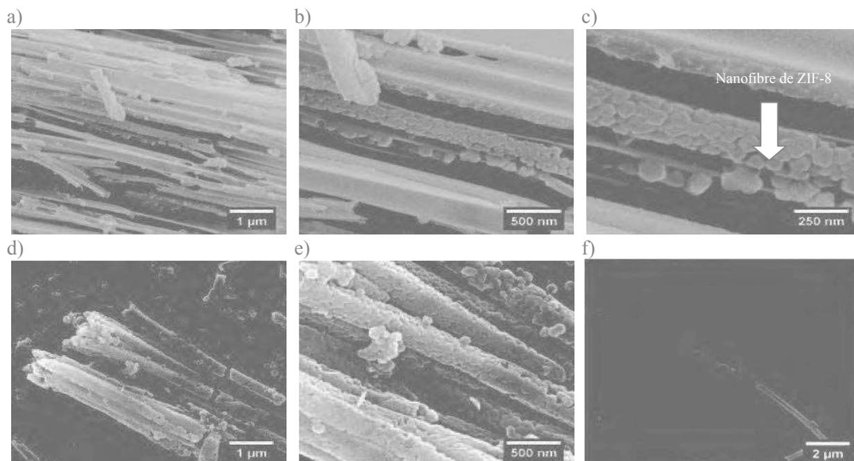
**Figure 3.27.** Clichés MEB, (a-c) vues transversales d'une membrane – NH<sub>2</sub> avec n=6 cycles après un temps d'immersion de 10 min dans NaOH 2M. (d-e) Nanostructures de ZIF-8 obtenues après dissolution complète de la membrane. (f) Nanostructure de ZIF-8 à l'état isolé permet d'apprécier les longueurs maximales de ces objets.
