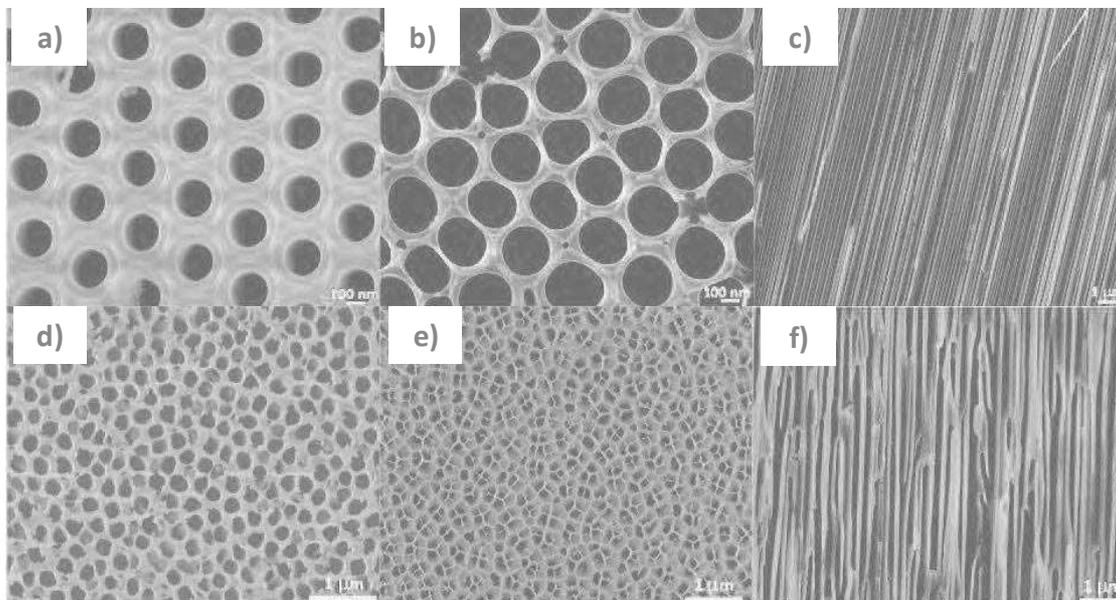
**Figure 1.26.** Clichés MEB pour une membrane d'oxyde d'aluminium hautement ordonnée (a-c) et pour une membrane d'alumine Anodisc 13 commerciale (d-f).<sup>82</sup>
