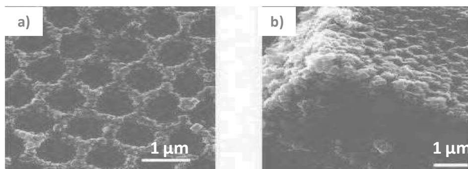
**Figure 1.17.** Clichés de microscopie à balayage des architectures 3D du MOF  $[Al(OH)(ndc)]_n$  obtenues par réplique de l'alumine.<sup>65</sup>
