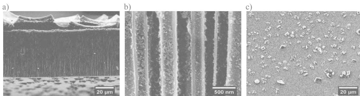
**Figure 2.35.** Clichés MEB de la tranche d'une membrane montrant le dépôt de  $8 \mu\text{m}$  du MOF  $\text{CuBPDC}(\text{NO}_2)_2$  à la surface de la membrane (a), de la région centrale d'une tranche de la membrane (b) et face B de la membrane composite (c).
