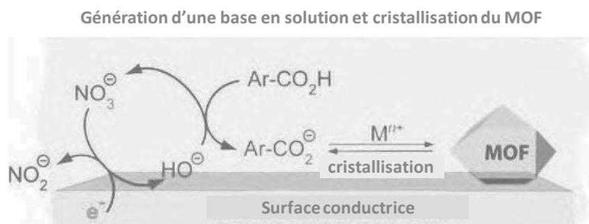
**Figure 1.31.** Mécanisme d'électrodéposition cathodique de MOFs sur une surface.<sup>103</sup>
