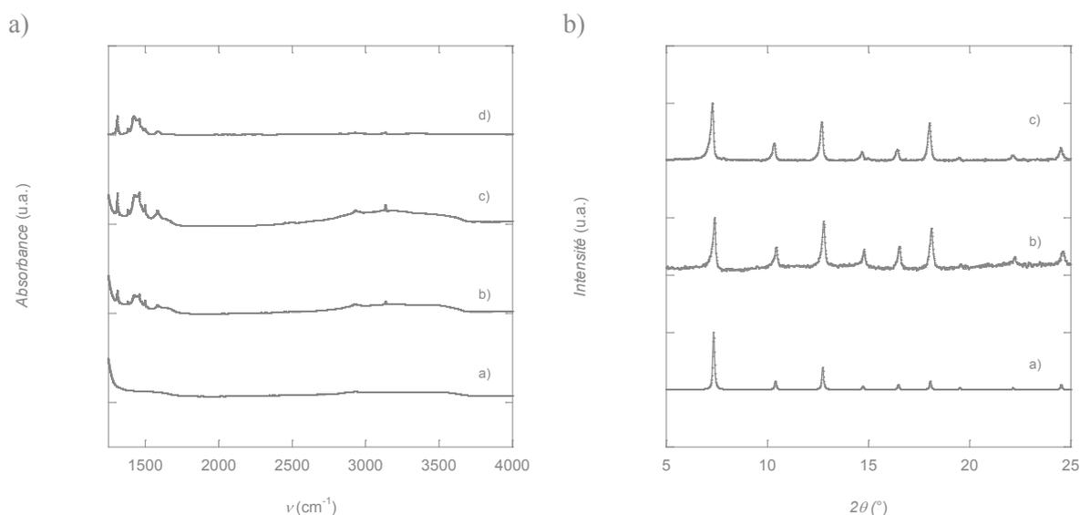
**Figure 3.13.** A gauche : Spectres infrarouge pour une membrane – NH<sub>2</sub> (a), pour une composite obtenue selon le protocole à 4 étapes de filtration (b), et selon le protocole à 3 étapes de filtration (c) et spectre ZIF-8 de référence (d). A droite : Diffractogrammes RX poudre pour ZIF-8 (simulé à partir de la structure RX) (a), pour une membrane composite obtenue selon le protocole à 4 étapes (b) et selon le protocole à 3 étapes (c).
