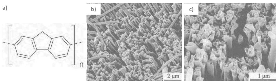
**Figure 1.35.** Molécule de polyfluorène utilisée (a) Clichés MEB des nanotubes de polyfluorène (b) et (c).<sup>108</sup>
