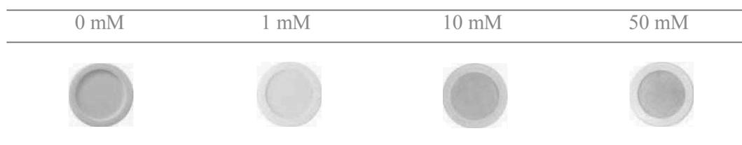
**Tableau 4.1.** Evolution de la coloration des membranes-  $\text{NH}_2$  composites pour  $n = 5$  cycles et des concentrations comprises entre 1 mM et 50 mM.
