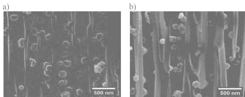
**Figure A3.1.** Clichés MEB d'une membrane - NH<sub>2</sub> (a) et d'une membrane à l'état de réception (b) avec n = 6 cycles de 3 étapes.
