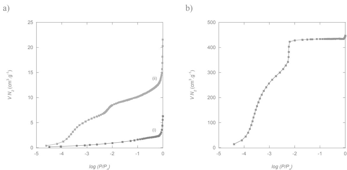
**Figure 3.22.** Isothermes d'adsorption de  $\text{N}_2$  (77K) tracées en coordonnées semi-logarithmiques de : la membrane d'alumine (i) et de la membrane –  $\text{NH}_2$  composite  $n = 6$  cycles (ii), (a) et de ZIF-8 dans sa version massive et (b).
