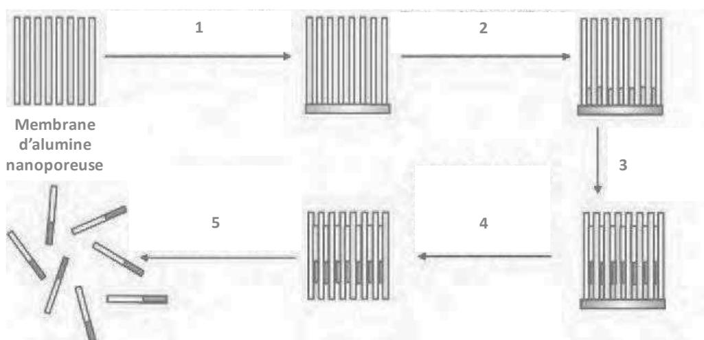
**Figure 1.29.** Schéma général pour la fabrication de nanostructures 1D par électrodéposition dans une membrane d'alumine.<sup>94</sup>
