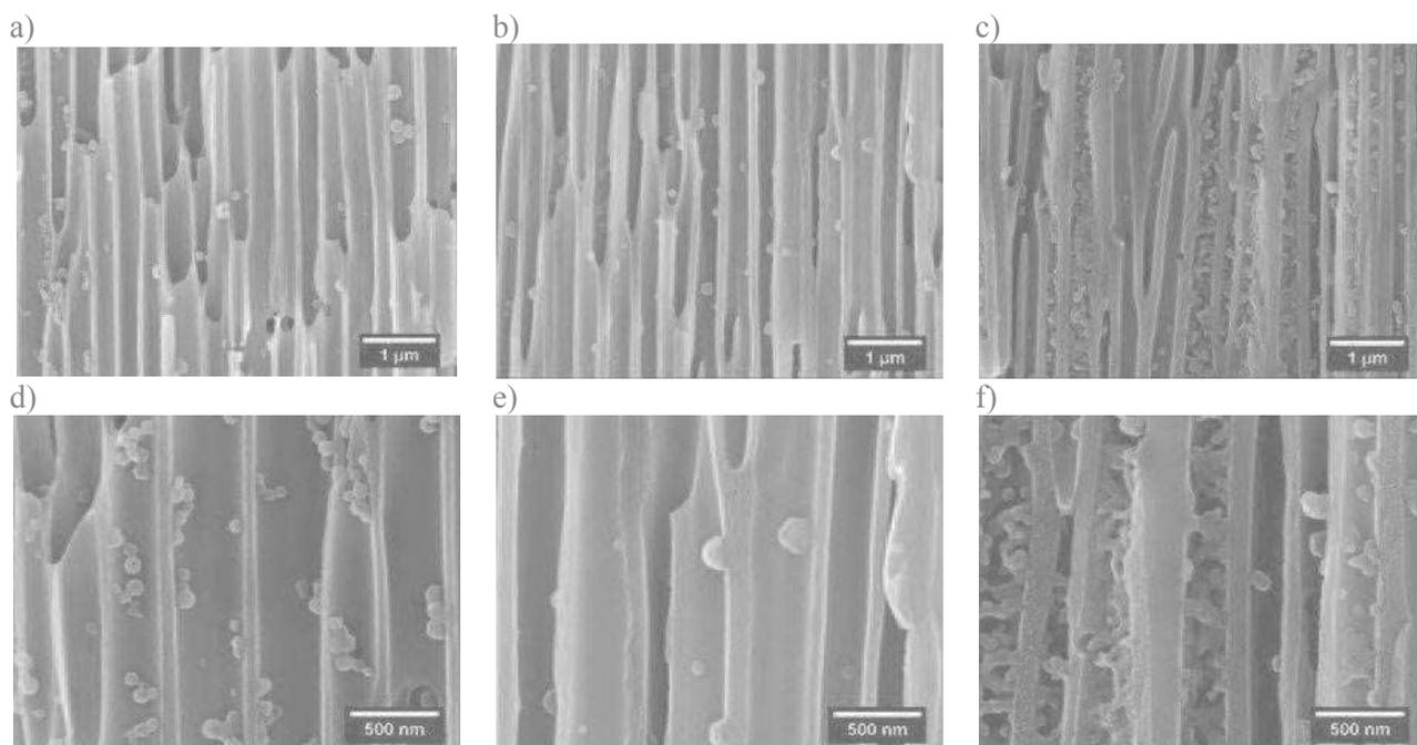
**Figure 3.11.** Clichés MEB pour la tranche d'une membrane-  $\text{NH}_2$  avec  $n = 15$  cycles à 4 étapes de filtrations : (a) à proximité de la face A, (b) région centrale, et (c) à proximité de la face B. Les images (d-f) correspondent à des zooms des régions montrées dans (a-c).
