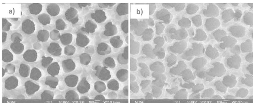
**Figure 1.27.** Clichés MEB pour une membrane d’oxyde d’aluminium commerciale (a) et pour une même après traitement thermique à 1000°C (b).<sup>85</sup>
