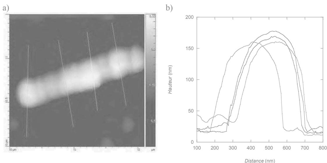
**Figure 3.29.** Clichés AFM (a) pour une nanostructure de ZIF-8 à l'état isolé déposée sur un wafer de silicium. Les profils de hauteur correspondent aux traits transversaux de la figure (a). Un diamètre moyen de cette nanostructure de 170 nm est déduit de ces profils de hauteur (b).
