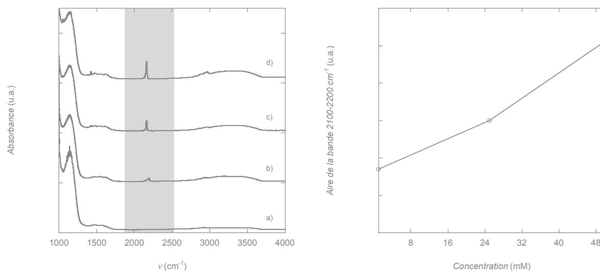
**Figure 4.12.** A gauche : Spectres infrarouge d'une membrane -  $\text{NH}_2$  pour  $n = 0$  cycles (a), et  $n = 5$  cycles pour une concentration en précurseurs de 1 mM (b), 10 mM (c) et 50 mM (d). La bande caractéristique des groupements cyano est surlignée en bleu, celle-ci nous sert de référence pour intégrer l'aire sous la courbe entre 2000-2500  $\text{cm}^{-1}$  (à droite).
