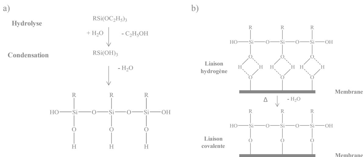
**Figure 2.4.** Hydrolyse/condensation des alcoxy-silanes et greffage de l'APTES à la surface de la membrane, (avec R = (CH<sub>2</sub>)<sub>3</sub>-NH<sub>2</sub>).
