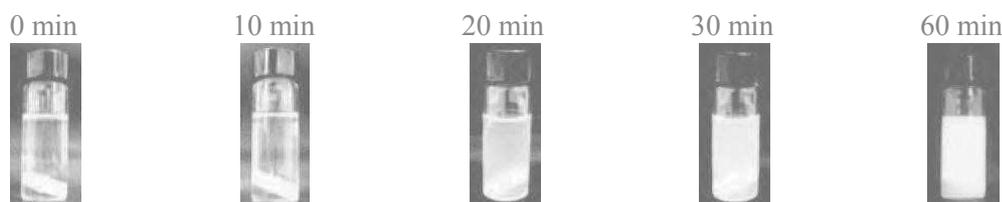
**Figure 3.12.** (a) Evolution de la taille des particules de ZIF-8 en fonction du temps de mélange, (b) Images montrant l'évolution de la suspension colloïdale de ZIF-8 en fonction du temps de mélange des réactifs.  $t = 0$  min correspond au mélange du nitrate de zinc (0,1 M) et du 2-méthylimidazole (0,4 M) dans le méthanol. La sédimentation des particules est observée pour des temps de mélange supérieur à 20 min.
