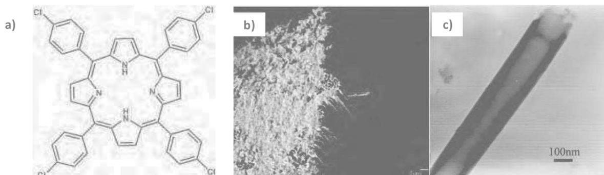
**Figure 1.36.** Molécule de porphyrine utilisée (a) Clichés MEB des nanotubes de porphyrine après élimination du substrat (b) et cliché MET d'un nanotube de porphyrine (c).<sup>112</sup>
