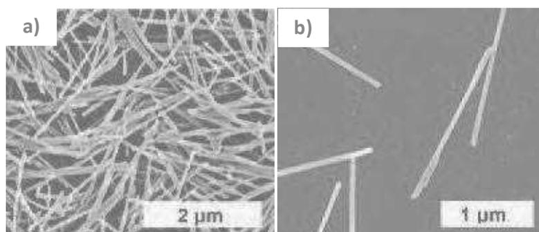
**Figure 1.18** Clichés MEB des nano-bâtonnets du MOF de  $\text{Gd}(\text{BDC})_{1,5}(\text{H}_2\text{O})_2$  obtenus par la technique de microémulsion inverse.<sup>66</sup>
