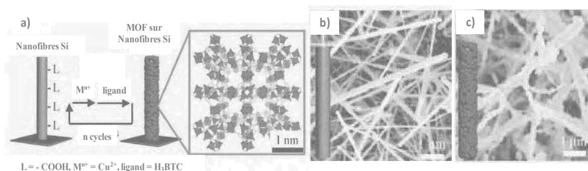
**Figure 1.19** Représentation schématique de la synthèse de HKUST-1 sur des nanofils de silicium (a), clichés MEB des nanofils de Silicium avant (b) et après dépôt de HKUST-1 (c).<sup>69</sup>
