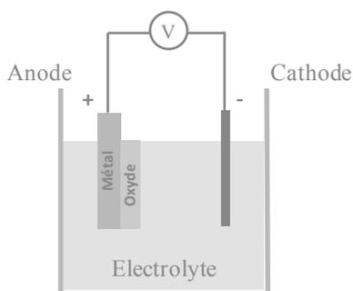
**Figure 1.23.** Montage expérimental pour l'anodisation de l'aluminium.
