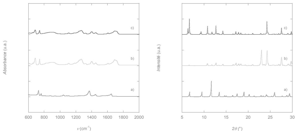
**Figure 2.40.** Spectres Infrarouge (à gauche) et diffractogrammes RX (à droite) : de HKUST-1 obtenu par synthèse solvothermale (a), de HKUST-1 après immersion 12h dans  $H_3PO_4$  5% (b), de  $H_3$ -BTC (c)
