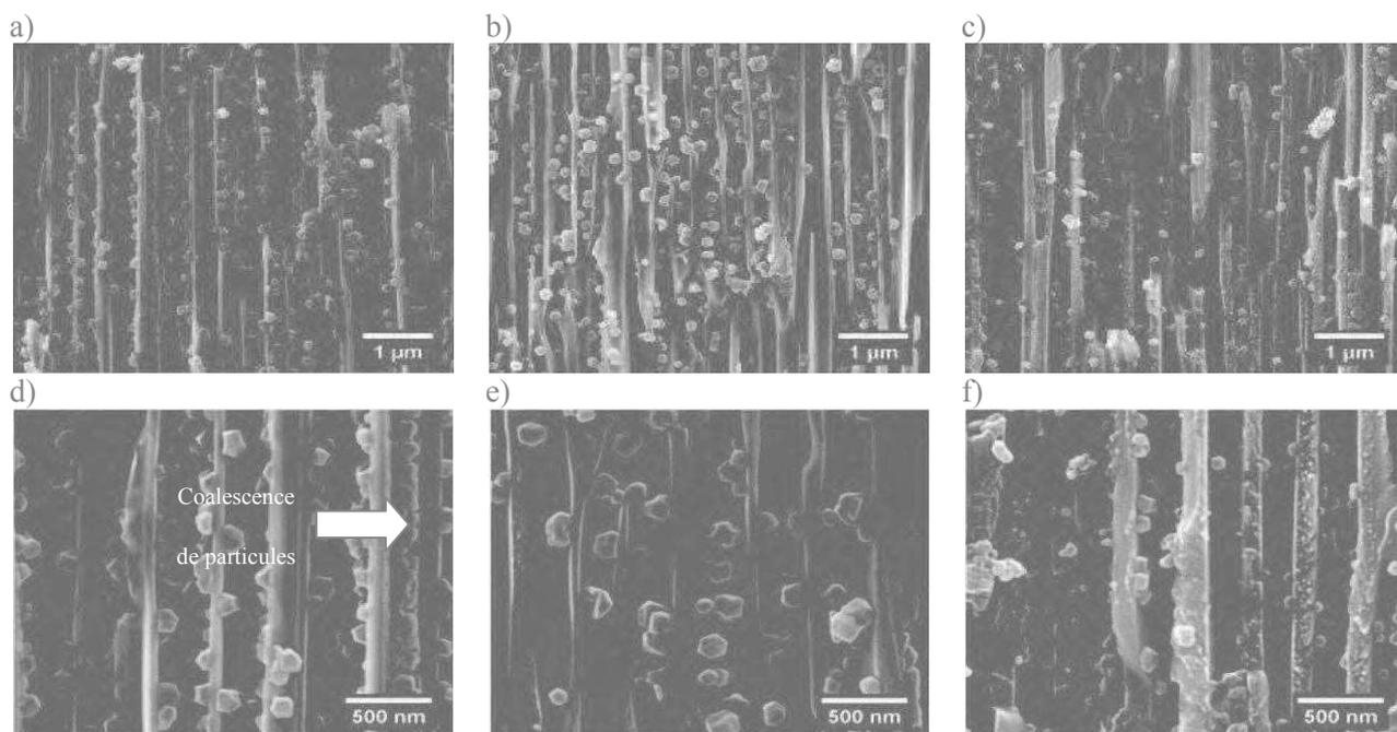
**Figure 3.19.** Clichés MEB pour la tranche d'une membrane-NH<sub>2</sub> avec  $n = 6$  cycles optimisés : (a) à proximité de la face A, (b) région centrale, et (c) à proximité de la face B. Les images (d-f) correspondent à des zooms des régions montrées dans (a-c).
