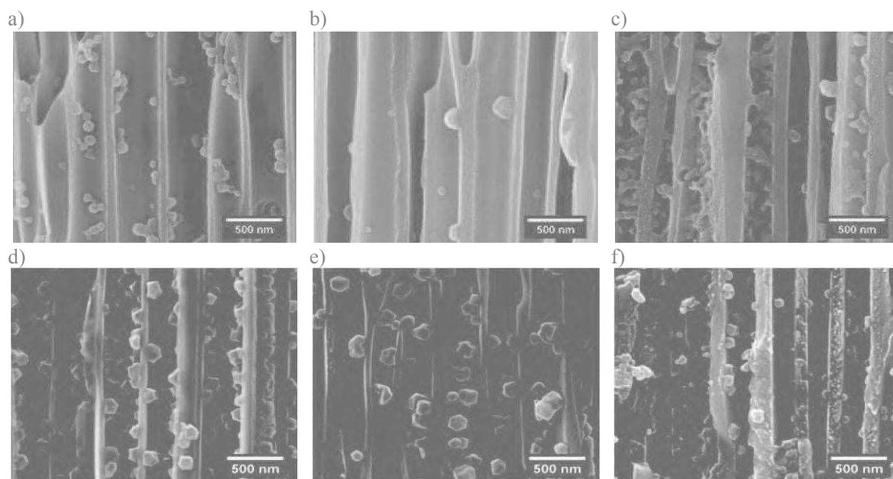
**Figure 3.14.** Clichés MEB pour la tranche d'une membrane – NH<sub>2</sub> avec n = 15 cycles à 4 étapes de filtration (a-c) et avec n = 6 cycles à 3 étapes de filtration (d-f). Les images (a et d) correspondent à une zone à proximité de la face A, (b et e) de la région centrale, et (c et f) à proximité de la face B.
