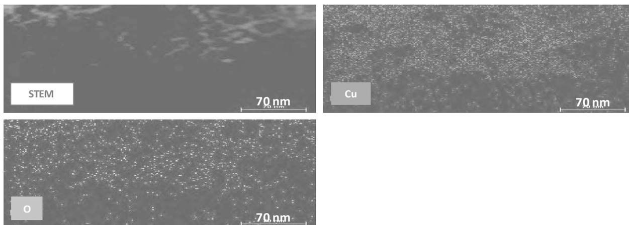
**Figure A2.4.** Image STEM des nano-objets obtenus après dissolution alcaline de la membrane HKUST-1 avec n = 20 cycles courts et cartographies correspondant des éléments cuivre et oxygène.
