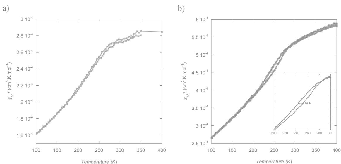
**Figure 4.17.** Evolution de  $\chi_M T$  en fonction de la température pour la membrane composite avec  $n = 5$  (a) et  $n = 10$  cycles (b). Le graphe dans l'encadré est un zoom de la plage de température 200-300 K du graphe (b).
