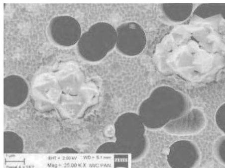
**Figure 1.22.** Cliché MEB des cristaux de HKUST-1 à la surface de la membrane PET.<sup>77</sup>
