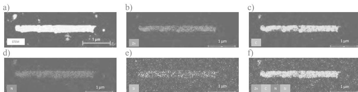
**Figure 3.31.** (a) Image de microscopie électronique à balayage par transmission (STEM), (b-f) et cartographies représentant la distribution spatiale des éléments Zn (b), C (c), N (d), Si (e), et Zn+C+N+Si (f).
