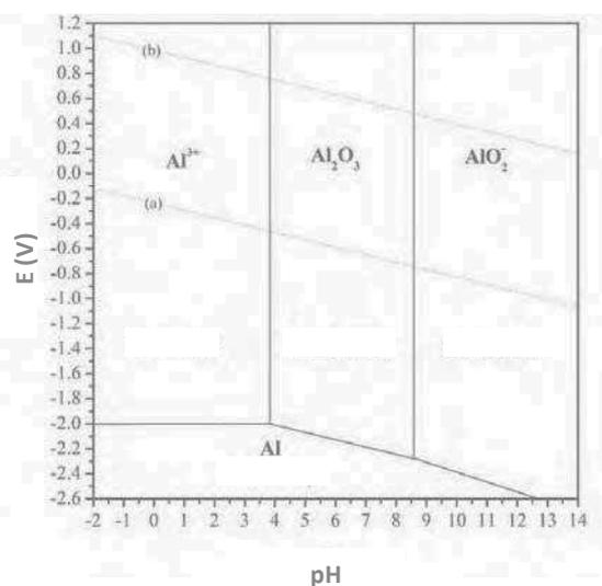
**Figure 1.39.** Diagramme de Pourbaix de l'aluminium, en solution aqueuse à 25°C, les droites (a) et (b) correspondent au domaine de stabilité de l'eau.<sup>119</sup>
