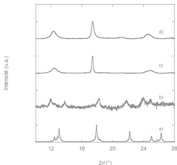
**Figure 4.13.** Diffractogrammes RX poudre pour (a)  $\text{Fe}(\text{pz})[\text{Ni}(\text{CN})_4]$  (simulé à partir de la structure RX), pour une membrane  $-\text{NH}_2$  pour  $n = 5$  cycles et une concentration en précurseurs  $C = 1$  mM (b)  $C = 10$  mM (c) et  $C = 50$  mM (d). Le décalage des pics de diffraction observé peut être dû à une différence entre la température d'enregistrement des diffractogrammes pour le monocristal (150 K) et pour les membranes composites (298 K).
