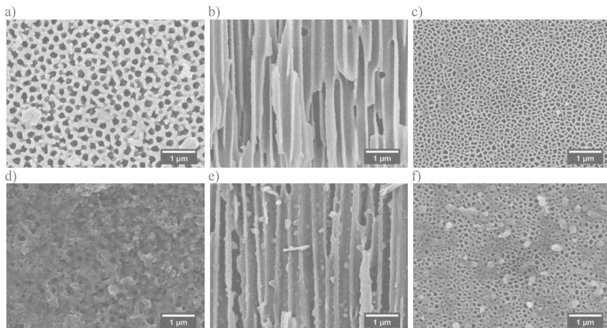
**Figure 2.14.** Clichés MEB d'une membrane HKUST-1  $n = 20$  cycles fonctionnalisée à l'APTES et d'une autre membrane sans fonctionnalisation (bas). Vue surfacique de la face A (a), vue transversale (région centrale de la membrane) (b) et vue surfacique de la face B (c)
