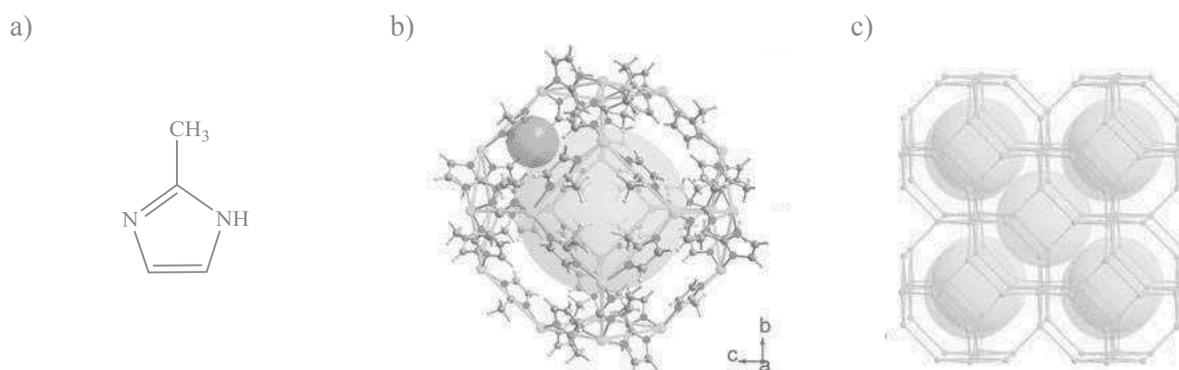
**Figure 3.3.** Ligand 2-méthylimidazole utilisé pour la construction de ZIF-8 (a), structure de ZIF-8 représentant l'association du zinc avec les ligands imidazolates (b, la sphère jaune a un diamètre de 12 Å et la sphère orange a un rayon de 3,4 Å). Représentation de la topologie sodalite (c).<sup>1,8</sup>
