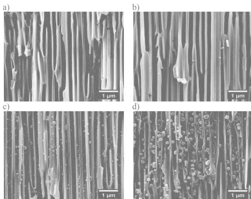
**Figure 3.15.** Clichés MEB pour la tranche d'une membrane – NH<sub>2</sub> avec n = 6 cycles à 3 étapes de filtration pour un ratio métal : Ligand 1 : 4 et une concentration en nitrate de zinc de (a) 5 mM, (b) 10 mM, (c) 50 mM et (d) 100 mM.
