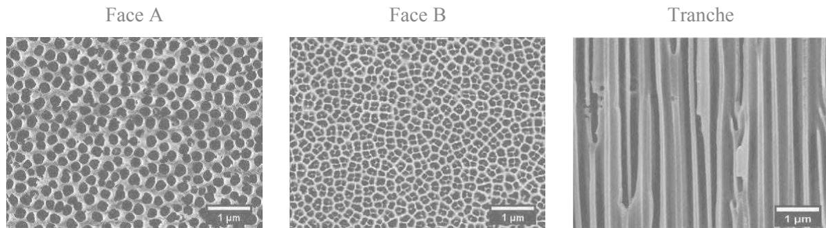
Figure E1. Faces A et B, et coupe transversale des membranes Whatman®.
