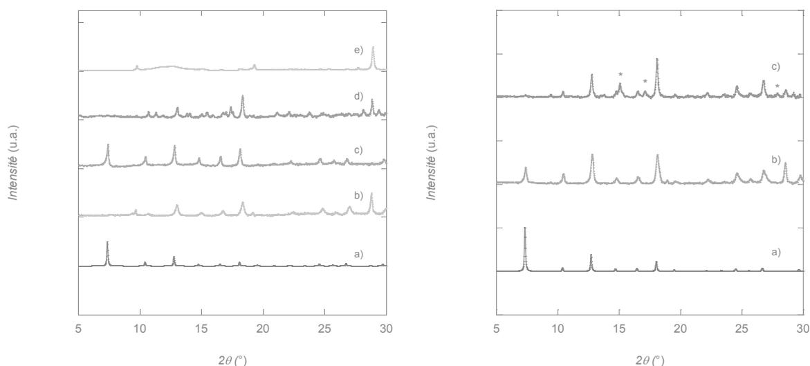
**Figure 3.10.** A gauche : diffractogrammes RX poudre pour ZIF-8 (a), pour une membrane – NH<sub>2</sub> composite avec n = 6 cycles obtenues en faisant varier le ratio M : L, (b) 1 : 2 (b), 1 : 4 (c), 1 : 6 (d) et 1 : 8. A droite : diffractogrammes RX poudre pour (a) ZIF-8 (calculé à partir de la structure RX), (b) pour une membrane – NH<sub>2</sub> (b) et pour une membrane à l'état de réception (c) avec n = 6 cycles à 3 étapes.
