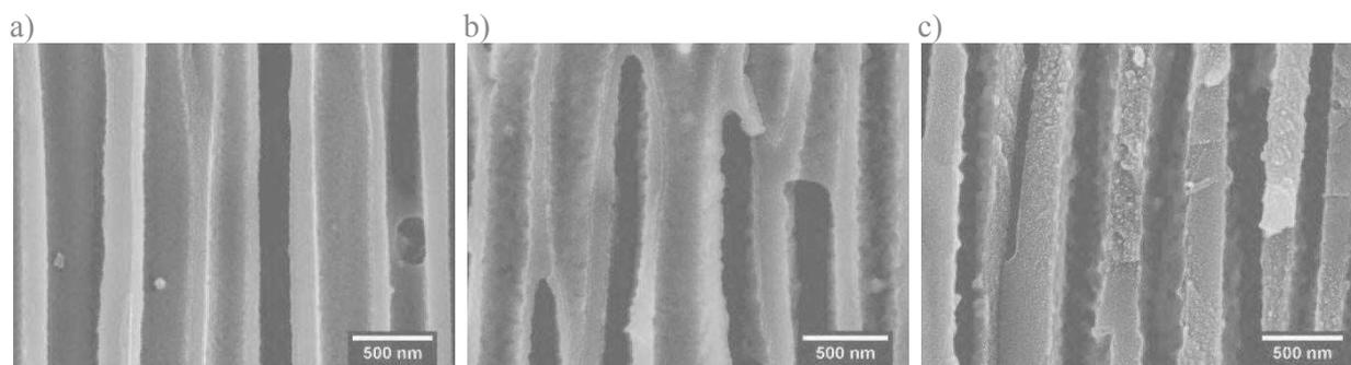
**Figure 2.19.** Clichés MEB de la tranche (région centrale) d'une membrane – NH<sub>2</sub> avec n=10 cycles (a), n = 20 cycles (b) et n = 30 cycles (c).
