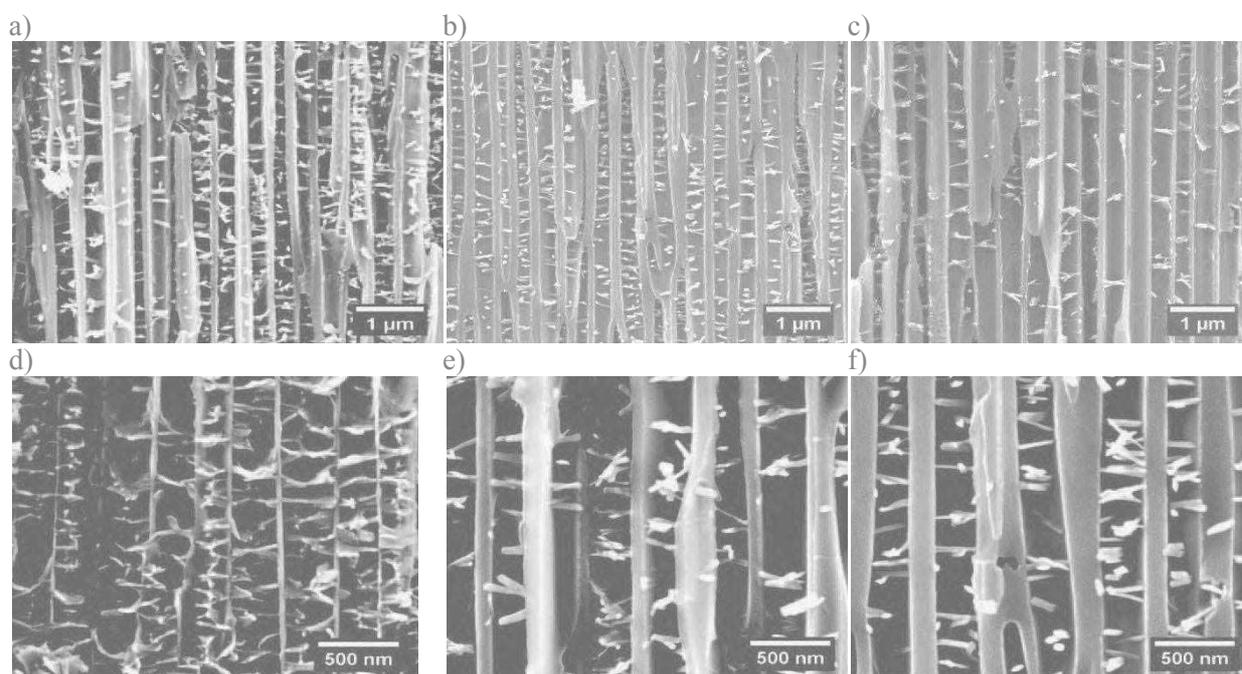
**Figure 2.28.** Clichés MEB pour la tranche d'une membrane –  $NH_2$   $n = 6$  cycles : (a) à proximité de la face A, (b) région centrale, et (c) à proximité de la face B. Les images (d-f) correspondent à des zooms des régions montrées dans (a-c).
