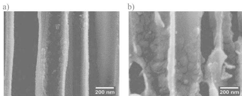
**Figure 4.16.** Clichés MEB pour la tranche (région centrale) d'une membrane -  $\text{NH}_2$  avec  $n = 5$  cycles (a) et  $n = 10$  cycles (b) permettant d'apprécier la taille des nanoparticules formées.
