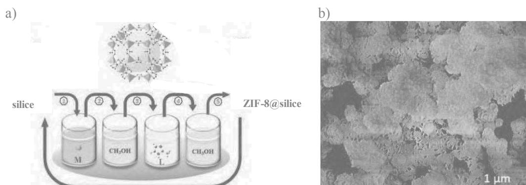
**Figure 3.7.** Représentation schématique pour la méthode étape-par-étape utilisée par Shekhah *et al.* pour la préparation de ZIF-8@silice mésoporeuse (a) Cliché MEB de ZIF-8@silice mésoporeuse après 10 cycles.<sup>22</sup>
