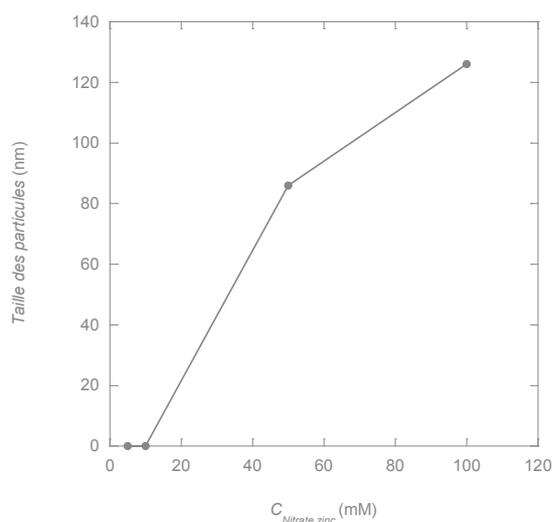
**Figure 3.16.** Evolution de la taille des particules en fonction de la concentration en nitrate de zinc utilisée pour la synthèse des membranes – NH<sub>2</sub> composites n = 6 cycles à 3 étapes.
