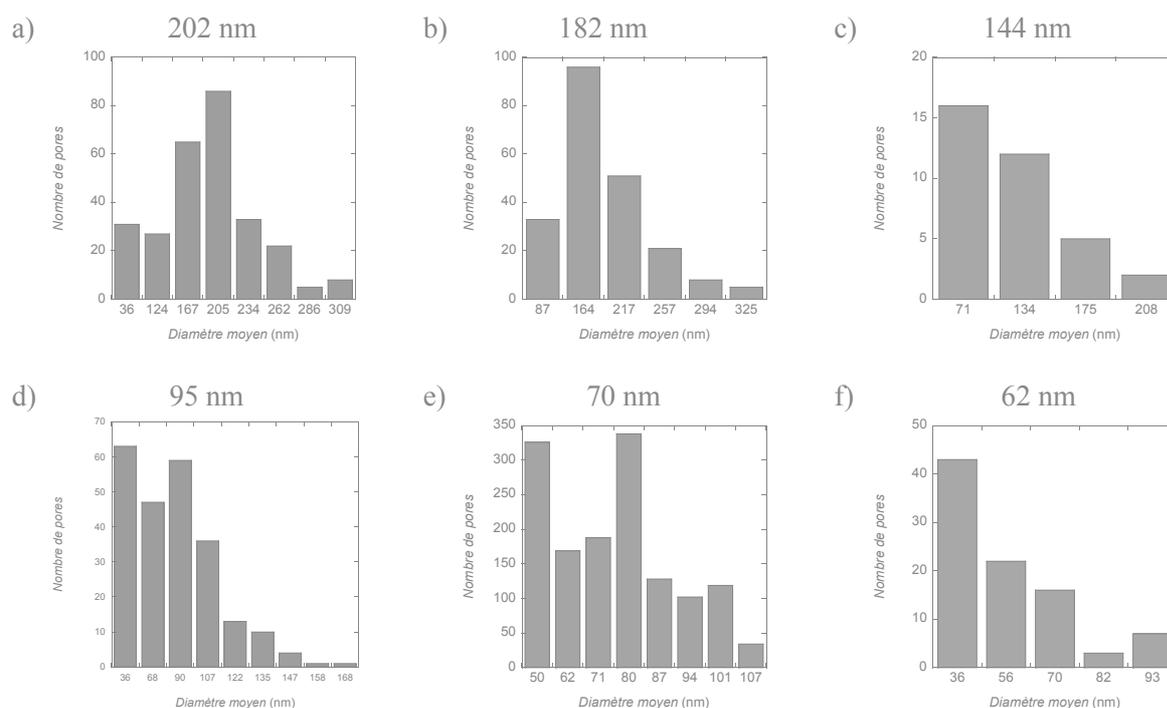
**Figure 2.18.** Histogrammes représentant la distribution des tailles de pores des membranes –  $\text{NH}_2$  pour les faces A (a-c) et les faces B (d-f). Violet :  $n = 10$  cycles, bleu :  $n = 20$  cycles, vert :  $n = 30$  cycles.
