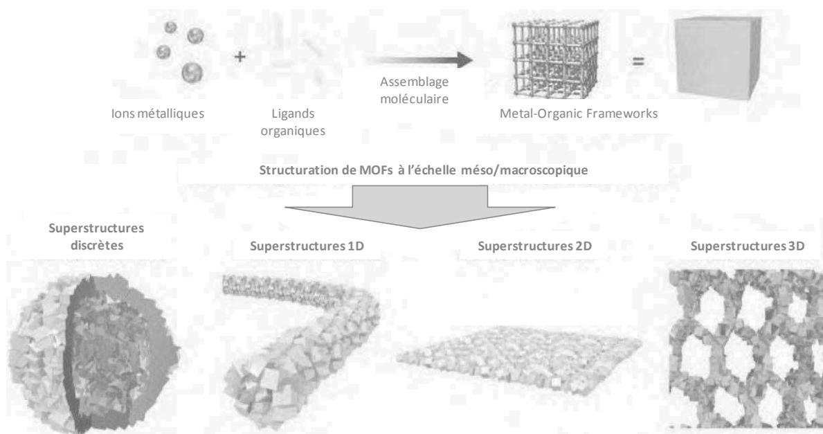
**Figure 1.** Représentation schématique de la structuration de MOFs à l'échelle méso/macrosopique. Par assemblage de nanocristaux de MOFs, des superstructures de dimensionnalités différentes sont générées. <sup>8</sup>
