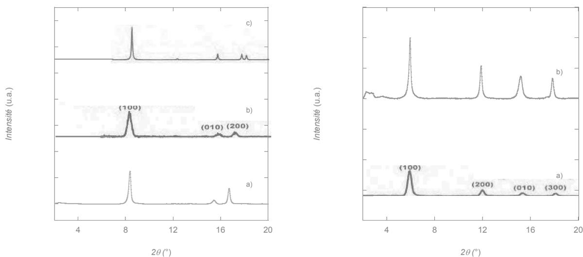
**Figure 2.30.** A gauche : diffractogrammes RX poudre d'une membrane avec  $n = 3$  cycles (a), de CuBDC construit sur une surface d'or fonctionnalisée, à l'interface d'un SAM (b) et simulé pour le matériau massif CuBDC (c). A droite : diffractogrammes RX de CuBPDC construit sur une surface d'or fonctionnalisée, à l'interface d'un SAM (a), et d'une membrane  $-NH_2$  avec  $n = 6$  cycles.
