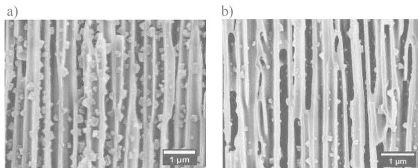
**Figure 2.11.** Clichés MEB de la tranche d'une membrane sans fonctionnalisation HKUST-1 n=6 cycles longs (a), n = 6 cycles courts (b).<sup>1</sup>
