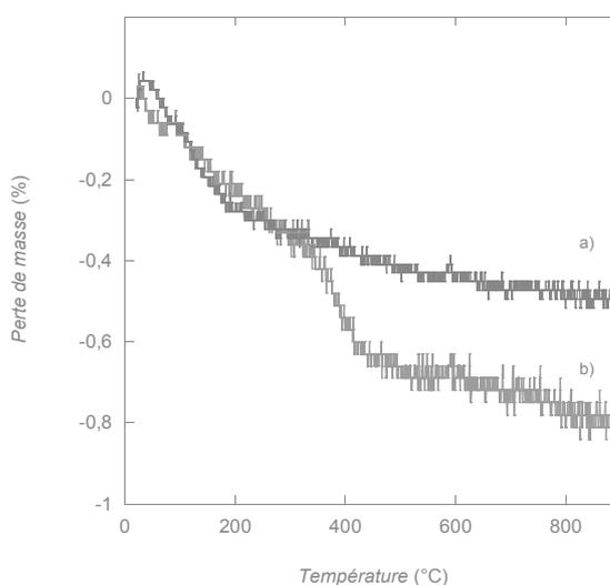
**Figure 2.7.** Perte de masse mesurée par ATG en fonction de la température pour la membrane d'alumine seule (a), et pour la membrane - NH<sub>2</sub> (b)
