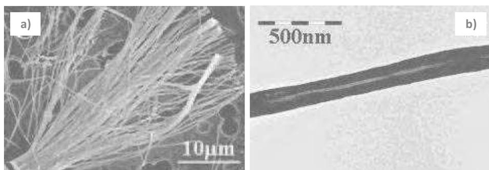
**Figure 1.38.** Clichés MEB des nanotubes d'organodiphosphonate de zirconium après dissolution de la matrice inorganique d'alumine (a), Cliché MET pour un nanotube (b).<sup>118</sup>
