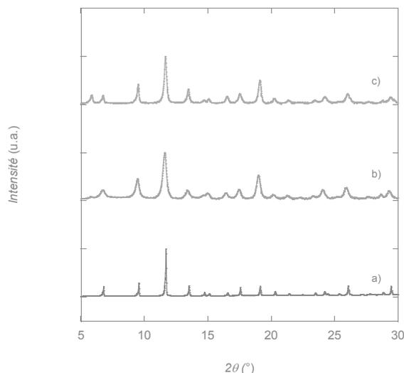
**Figure 2.13.** Diffractogrammes RX poudre pour (a) HKUST-1 (calculé à partir de la structure RX), (b) pour une membrane – NH<sub>2</sub> n = 20 cycles courts et (c) pour une membrane n = 6 cycles longs.
