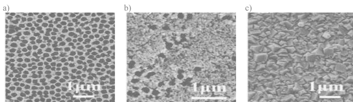
**Figure 3.5.** Clichés MEB de la face A de la membrane d'alumine (a), après synthèse de germes (b) et après croissance de ZIF-8 (c).<sup>16</sup>
