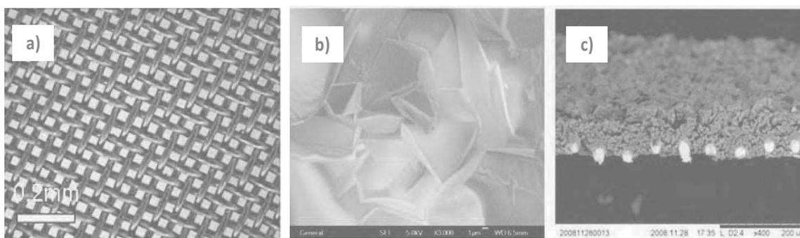
**Figure 1.14** Microscopie optique de la grille de cuivre (a), clichés MEB de la surface (b) et de la tranche de la membrane de HKUST-1 (c).<sup>58</sup>
