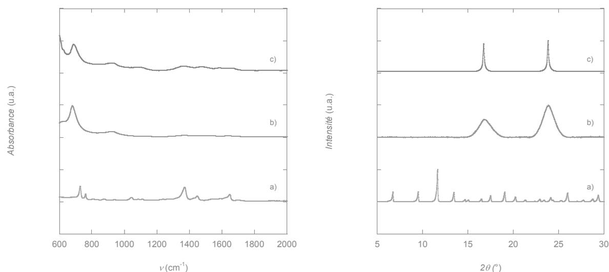
**Figure 2.38.** Spectres Infrarouge (à gauche) et diffractogrammes RX (à droite) : de HKUST-1 obtenu par synthèse solvothermale (a), de HKUST-1 après immersion 20 min dans NaOH 2M (b), de Cu(OH)<sub>2</sub> (c)
