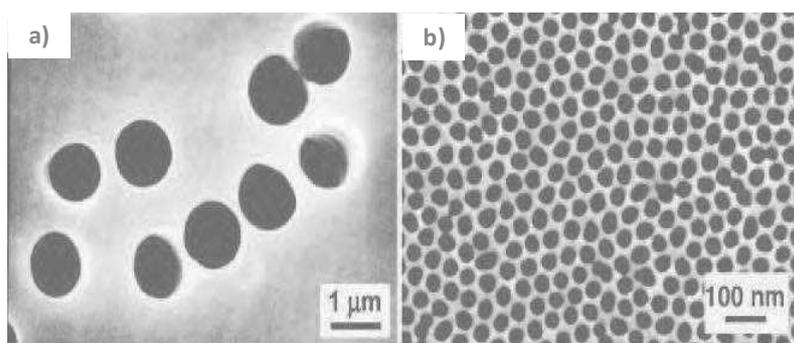
**Figure 1.21.** Clichés MEB de la surface d'une membrane polycarbonate ( $\varnothing_{\text{pores}} = 1 \mu\text{m}$ ) (a) et de la surface d'une membrane d'alumine ( $\varnothing_{\text{pores}} = 35 \text{ nm}$ ) (b).<sup>76</sup>
