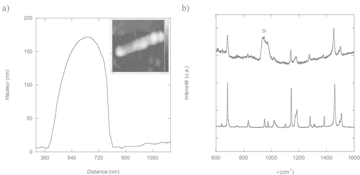
**Figure 3.32.** Mesures AFM couplées au Raman, (a) Profil de hauteur correspondant à l'image AFM de la nanostructure étudiée dans l'encadré, (b) spectres Raman pour la poudre de ZIF-8 synthétisée à température ambiante (bas), et pour la nanostructure de ZIF-8 (haut) montrée sur la figure (a). Le signal large entre 910 – 1000  $\text{cm}^{-1}$  est attribuable au wafer de silicium utilisée pour déposer les nanostructures lors de l'analyse.
