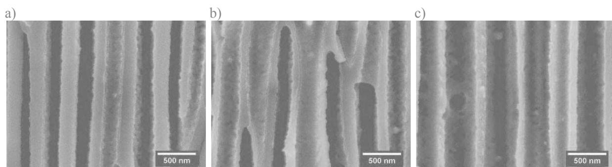
**Figure 2.15.** Clichés MEB de la tranche d'une membrane HKUST-1  $n=20$  cycles fonctionnalisée à l'APTES. Vue transversale à proximité de la face A (a), vue transversale de la région centrale (b) et vue transversale à proximité de la face B (c).
