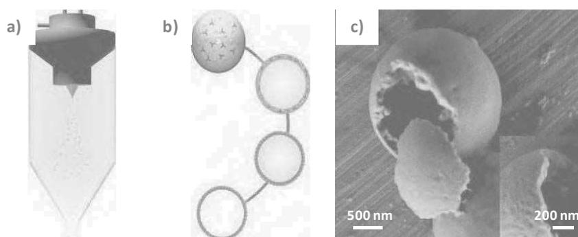
**Figure 1.12.** Dispositif expérimental permettant l'élaboration des capsules de HKUST-1 (a), mécanisme hypothétique de formation des nanostructures sphériques de HKUST-1 (b), MEB d'une capsule endommagée pour observer sa macrocavité ainsi que l'épaisseur de sa paroi de MOFs (c).<sup>46</sup>
