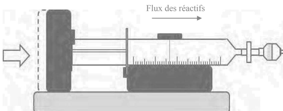
Figure E2. Représentation schématique du dispositif de filtration membranaire.
