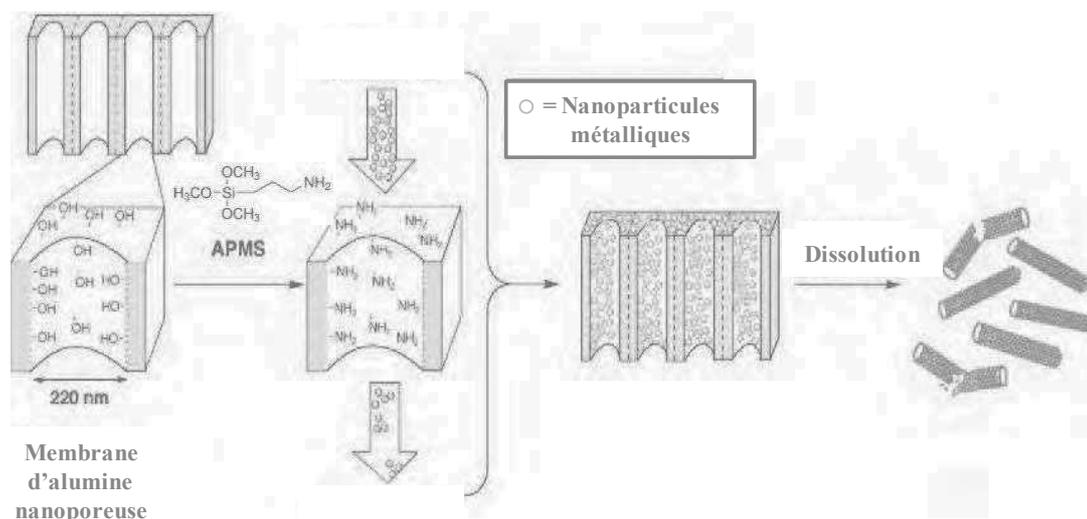
**Figure 1.32.** Représentation schématique de la préparation des nanotubes métalliques.<sup>104</sup>
