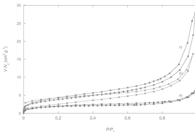
**Figure 2.32.** Isothermes d'adsorption de N<sub>2</sub> (77K) pour un lot de membranes d'alumine (a), pour un lot de membrane CuBDC (b) et pour un lot de membranes CuBPDC (c).
