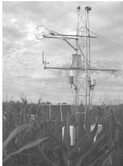
Figure 4. Illustration d'une tour à flux : Les capteurs de mesure d'humidité, de température et de vitesse de vent sont disposés à plusieurs niveaux, afin d'estimer l'évapotranspiration au dessus d'un champ de maïs.
