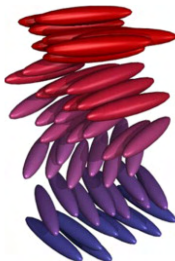
FIGURE 1.2 – Représentation de l'organisation des molécules pour la phase cholestérique. La direction du vecteur directeur \vec{n} n'est pas constante dans l'espace, le directeur est parallèle au grand axe des molécules. Les molécules forment une structure en hélice.
