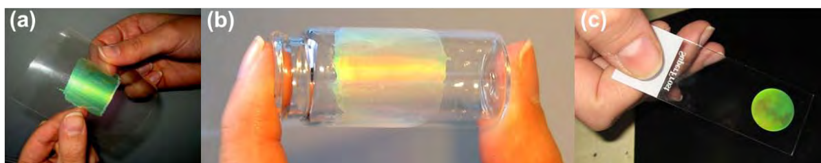
FIGURE 2.7 – Film optique sur différents substrats. (a) Une feuille de plastique flexible - (b) un substrat solide courbe - (c) une lame de verre, c'est le cas qui correspond aux échantillons étudiés dans ce chapitre. La couleur du film dépend des conditions d'illumination.
