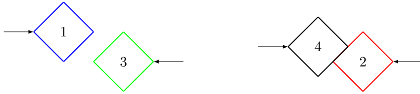
FIGURE 5.7 – Étape 4 : on ajoute la particule 4 à t_3 avec vitesse v_1 en position précollisionnelle.
