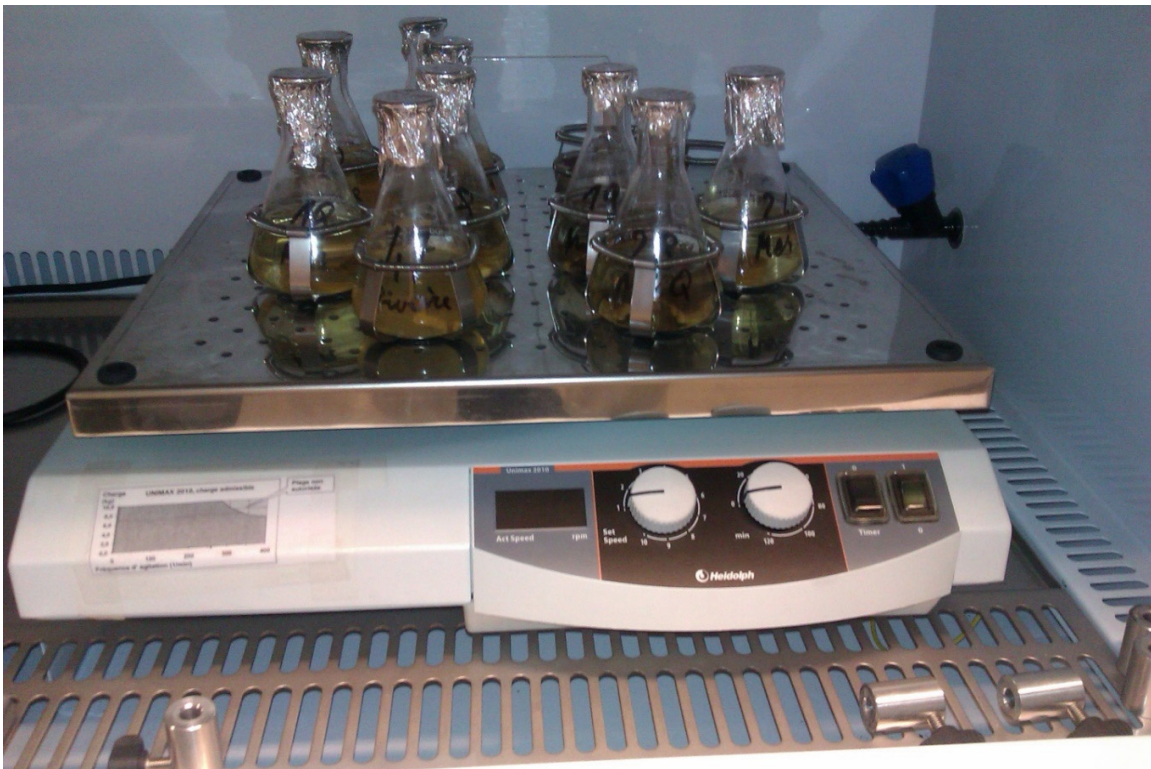
Photo d'une table agitante avec quelques erlenmeyers en fin d'expérience.
