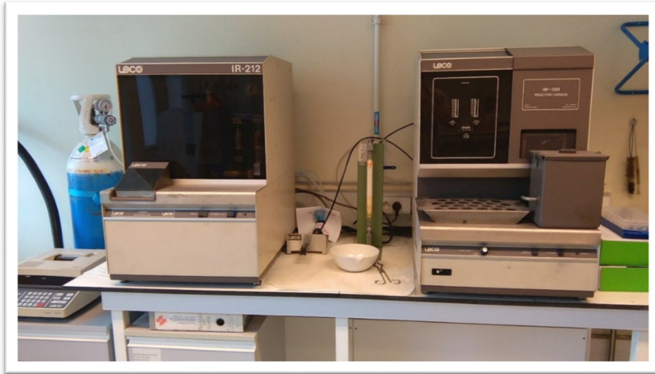
Photo III-1 : LECO automatic carbon determinator IR-212 de l'ISTeP (Paris 6).
