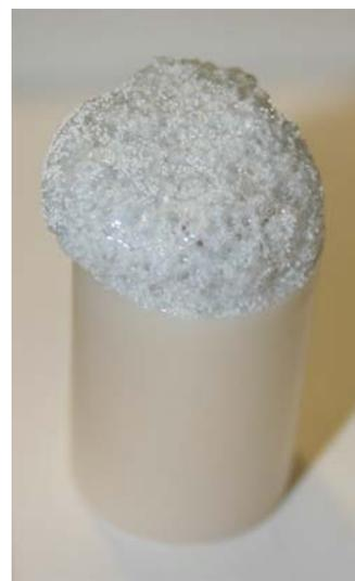
(a) Échantillon n°51 : 700 mg, 81 wt%  $\text{NS}_2$ -19 wt%  $\text{CaCO}_3(\text{M})$ , soit une composition équivalente en oxydes de 58,1-12,0-29,9. Histoire thermique : 45 min à  $900^\circ\text{C}$ .
