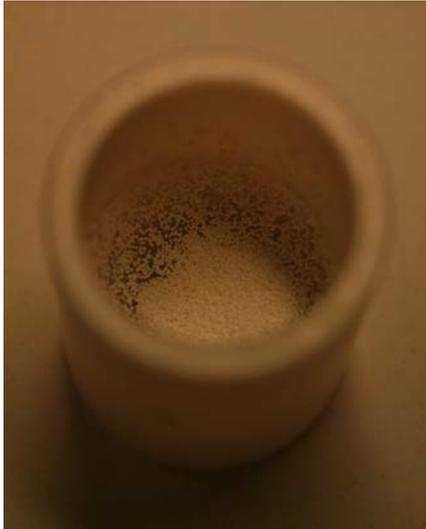
(a) Échantillon n°37 : 4.21 g, 89 wt% NS<sub>2</sub>-11 wt% CaO(M), soit une composition équivalente en oxydes de 58,7-11,0-30,3. Histoire thermique : 45 min à 900°C. Le creuset mesure 20 mm de diamètre.
