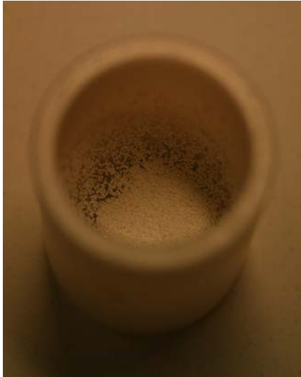
(a) Échantillon n°37 : 4.21 g, 89 wt% NS 2 -11 wt% CaO(M), soit une composition équivalente en oxydes de 58,7-11,0-30,3. Histoire thermique : 45 min à 900°C. Le creuset mesure 20 mm de diamètre.
