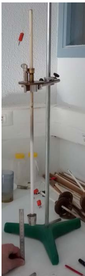
(a) Dispositif de suspension. Le (b) Courbe d'homogénéité de la température du four tubulaire réglet métallique mesure 16 cm sous un balayage de 250 sccm de \text{CO}_2 .
