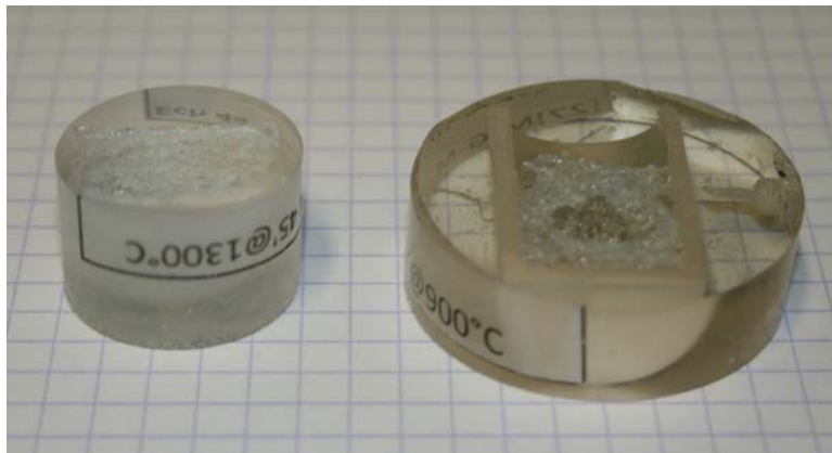
FIGURE 2.3 – Plots de 25 mm et 40 mm ; le quadrillage mesure 5 mm de côté. Le plot de gauche contient la section verticale d’une carotte de verre élaboré à 1300°C pendant 45 min. Le plot de droite, métallisé au platine et couvert sur sa partie gauche de laque d’argent, contient un demi-creuset de 20 × 30 mm renfermant du mélange vitrifiable partiellement fondu.
