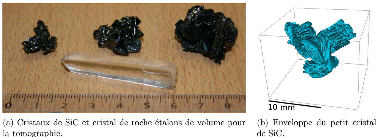
FIGURE 3.18 – Cristaux de référence (a) et exemple de reconstruction 3D (b) après seuillage du volume tomographique.
