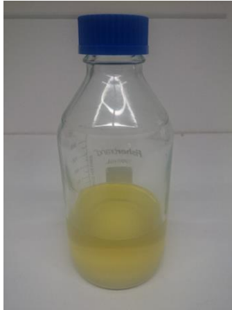
Huile de coton carbonaté, extrêmement visqueuse à basse température
