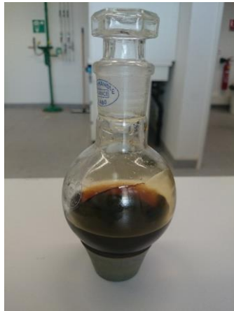
Huile de coton carbonaté, extrêmement visqueuse à basse température
