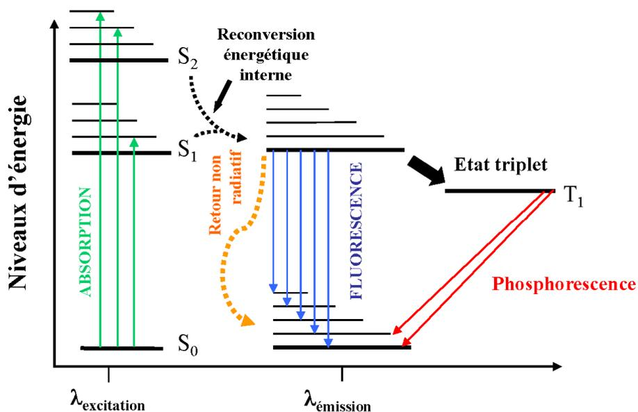
Figure 38 : Diagramme de Jablonski représentant la fluorescence
