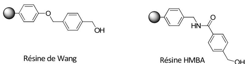
Figure 104: Structure des résines de Wang et HMBA
