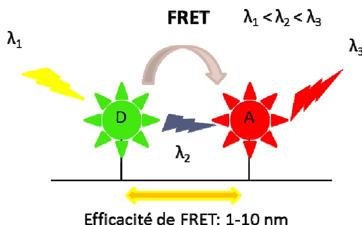
Figure 39 : Transfert de fluorescence entre un fluorophore donneur et un fluorophore accepteur
