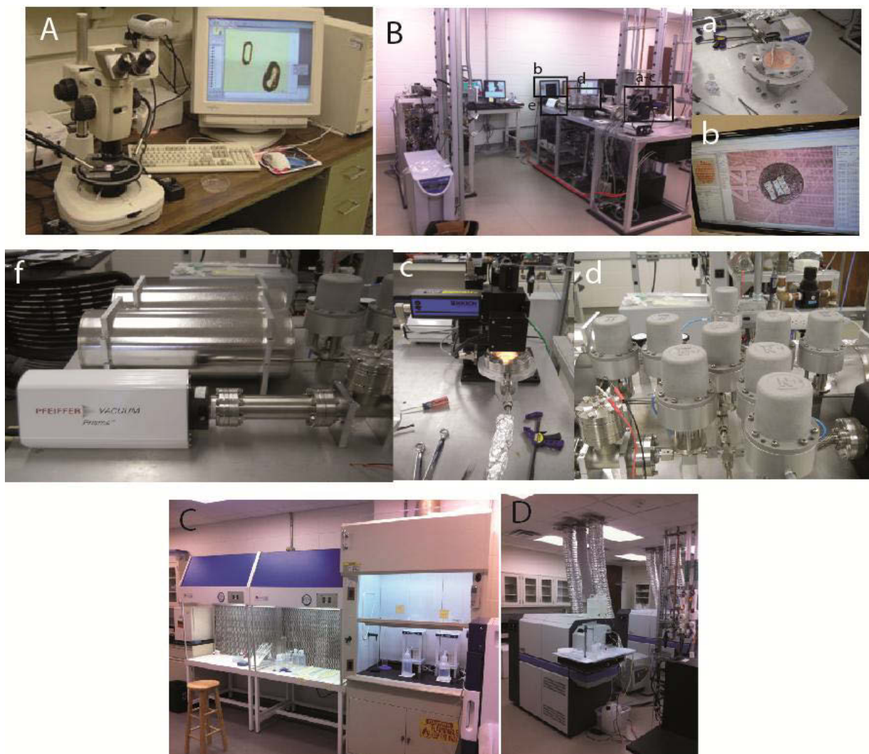
Figure 4 : Matériel utilisé au cours des analyses Hélium à la Jackson School of Geoscience de l'Université du Texas (Austin) dans le laboratoire de Daniel Stockli. A) Microscope optique utilisé pour l'étape de sélection manuelle des grains. B) Matériel utilisé pour le dégazage : a, disque de platine contenant les 44 échantillons prêts à être dégazés, b, paramétrage XY pour le dégazage automatique des échantillons (au centre de trou est disposé l'aliquote d'un échantillon), c, Laser servant à dégazer les grains, d, chambres à injection de gaz cryogénique, e, spectromètre de masse quadripolaire. C) Laboratoire où la dissolution des grains est faite. D) ICP-MS pour la quantification des éléments U et Th.
