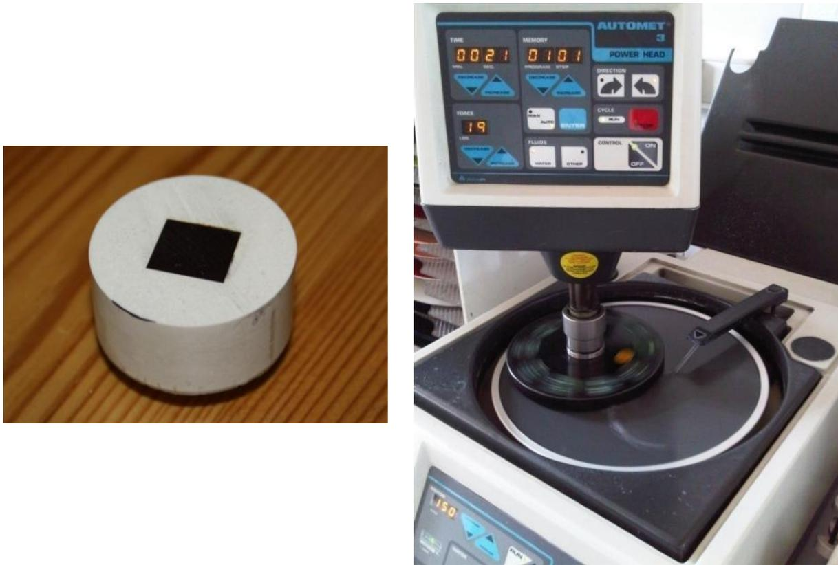
Figure III.15 : Dispositif de polissage mécanique de l'EMSE
