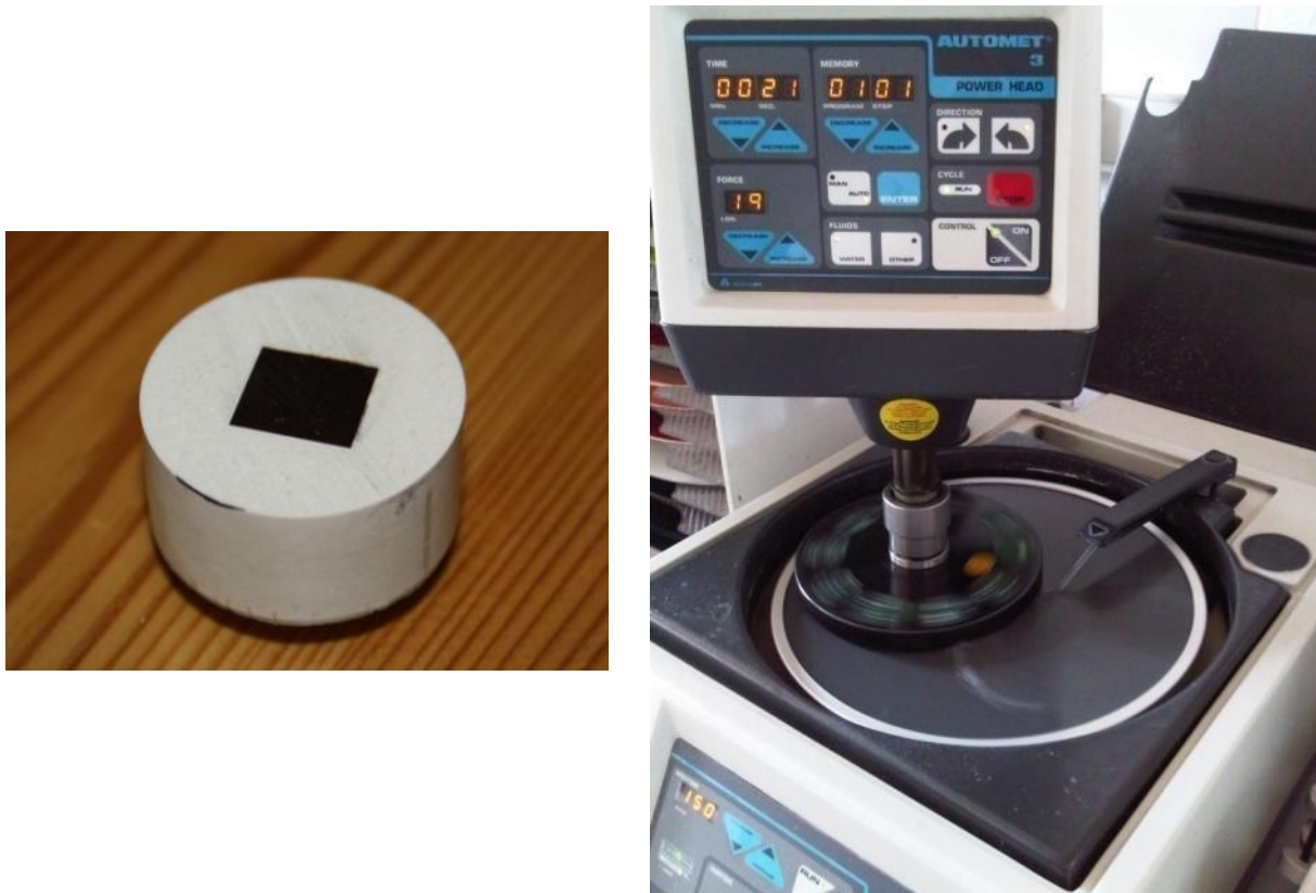
Figure III.15 : Dispositif de polissage mécanique de l'EMSE
