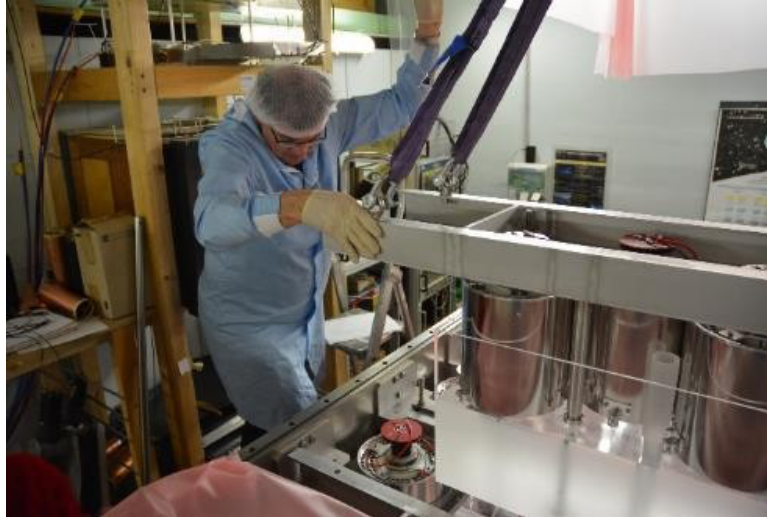
FIGURE 2.26 – Photos des tubes photomultiplicateurs dans le volume tampon prêt à être insérer au dessus d'une cellule.
