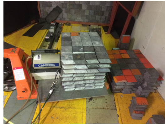
FIGURE 3.24 – Détecteur germanium pointant vers l'expérience IN20
