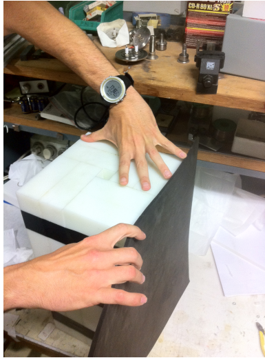
FIGURE 3.33 – Petite boîte de polyéthylène recouverte de B_4C — boîte B_4C
