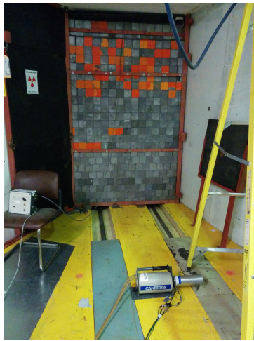
FIGURE 3.14 – Position de référence définie pour la mesure de l'ambiance gamma dans la casemate.
