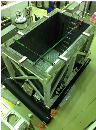
FIGURE 3.28 – Photo des blindages internes en plomb.
