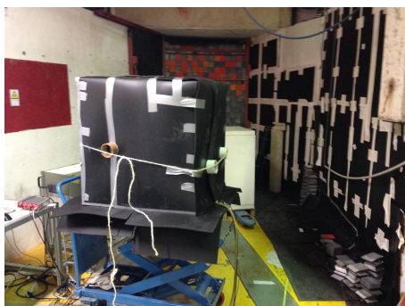
FIGURE 3.16 – Détecteur germanium recouvert par la boîte en feuille de B 4 C.
