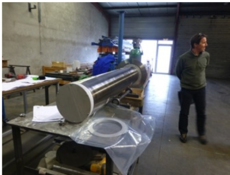
FIGURE 3.13 – Photo du bouchon utilisé dans la ligne de faisceau H7
