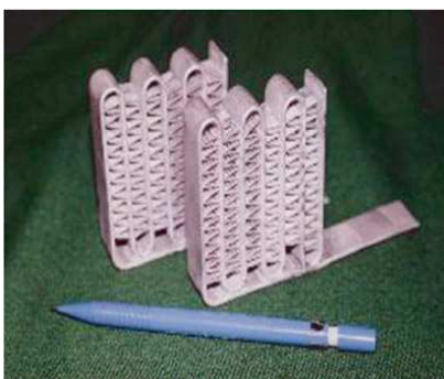
(b) PHP pour le refroidissement d'électronique informatique, [5].
