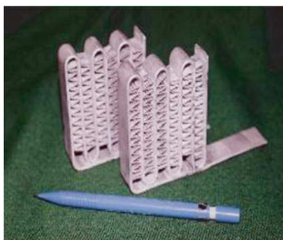
(b) PHP pour le refroidissement d'électronique informatique, [5].
