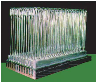
(a) PHP pour le refroidissement d'électronique de puissance, proposé par Akachi et Polasek [5].
