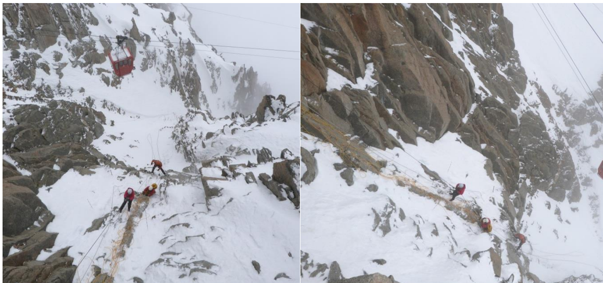
Figure 7.1. Ligne d'acquisition géoélectrique installée le 26/09/2013 sur la face NE de l'Aiguille du Midi (photos : P. Deline).
