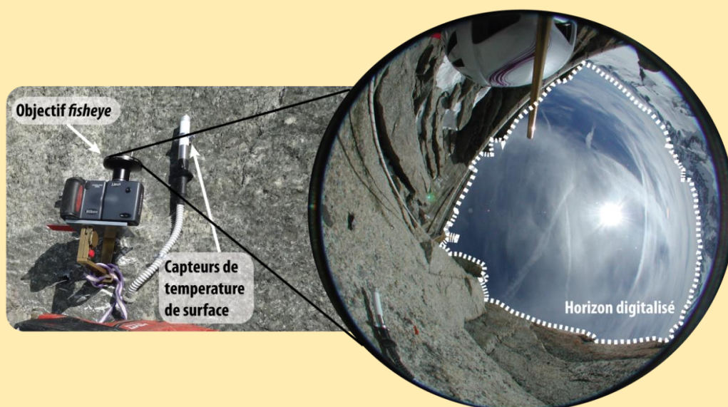
Figure 4.4. Appareil photo avec objectif fisheye , et photo à l'emplacement du capteur E1.
