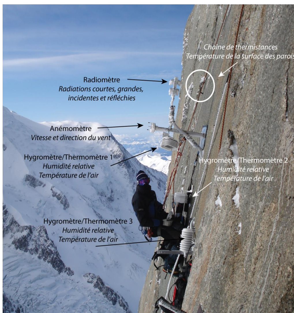
Figure 3.5. Dispositif de mesures des paramètres climatiques en face sud de l'Aiguille du Midi. Photo : U. Morra di Cella.
