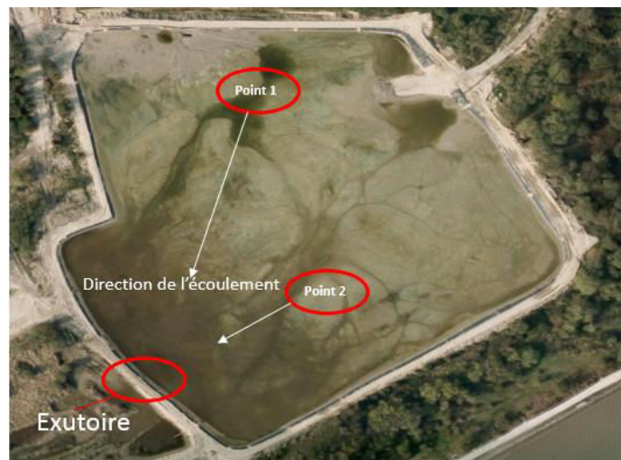
Figure II-1 : Positionnement des points de prélèvement de la chambre de dépôt de Tancarville
