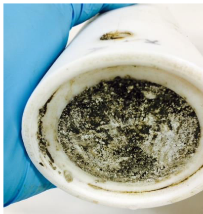
Figure III-13 : Précipitation des sels citrates de couleurs blanche dans les sédiments près de la sortie de la cathode
