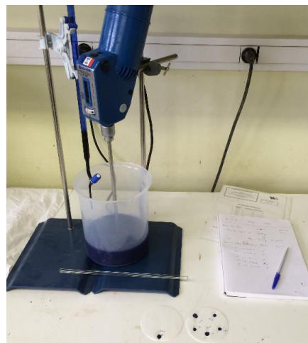
Figure II-6 : Système d'essai au bleu méthylène
