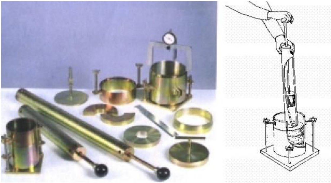
Figure II-7 : Matériels et méthode de réalisation des essais Proctor
