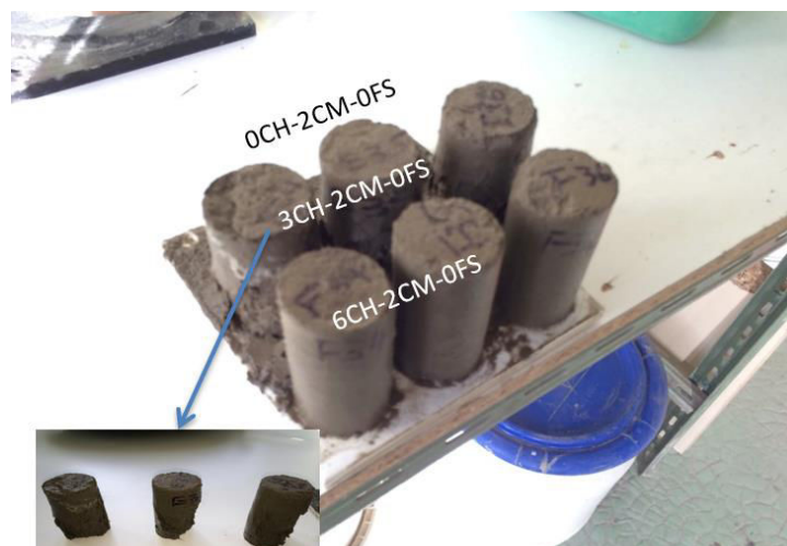
Figure IV-15 : Echantillons traités avec 2% du ciment et de 0%, 3% et 6% de la chaux après 24 heures de mouillage
