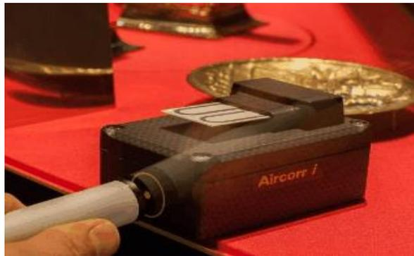
**Figure 1.9 : AirCorr I, version d'intérieur, avec capteur de corrosion échangeable.**
