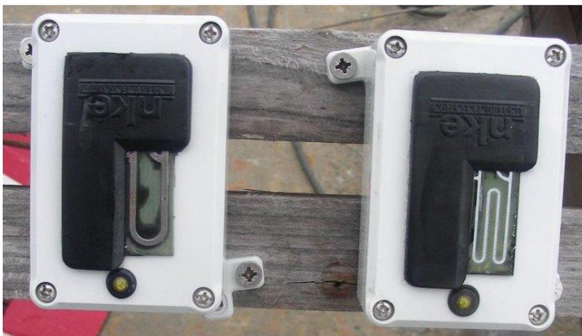
**Figure 1.10 : Photographie des capteurs Aircorr O (ECAT) en acier 250 µm (gauche) et zinc 25 µm (droite) de dernière génération.**
