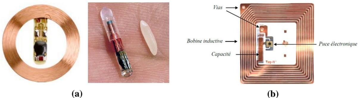
Figure 1.20 : Exemple de tags RFID à BF (a) et en bande HF (b).
