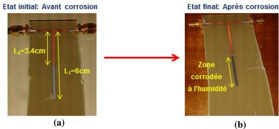
**Figure 2.52 : Stub résonateur avant corrosion (a) et après corrosion (b).**
