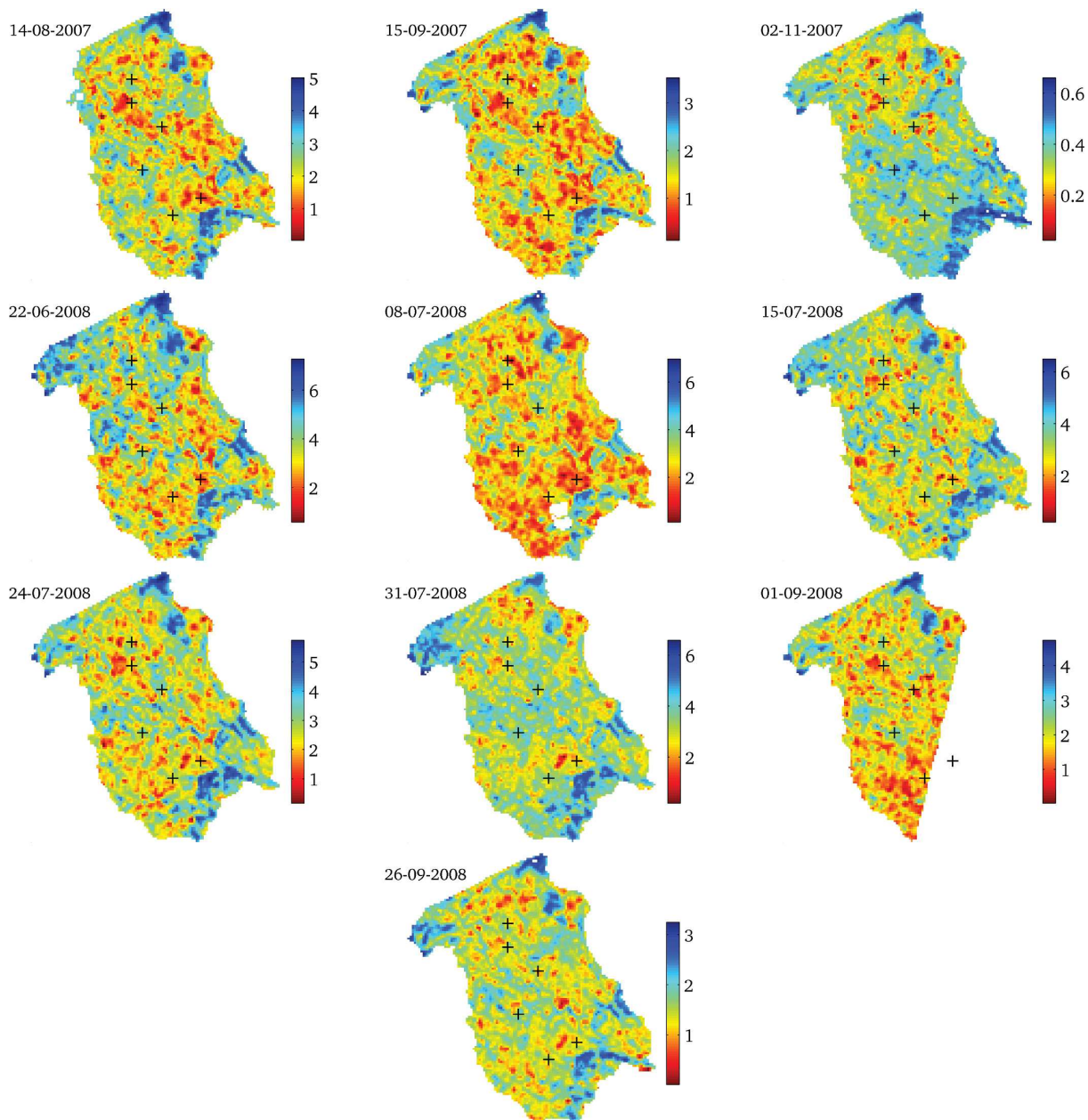
FIGURE C.1 – Cartes d'ETR S-SEBI ASTER ( \text{mm j}^{-1} ) obtenues par la méthode S-SEBI et utilisées pour la calibration du modèle TSVA. Les signes + représentent les parcelles d'application du modèle. Une échelle de couleurs différentes a été utilisée pour chaque carte afin de mieux apprécier la distribution spatiale de l'ETR
