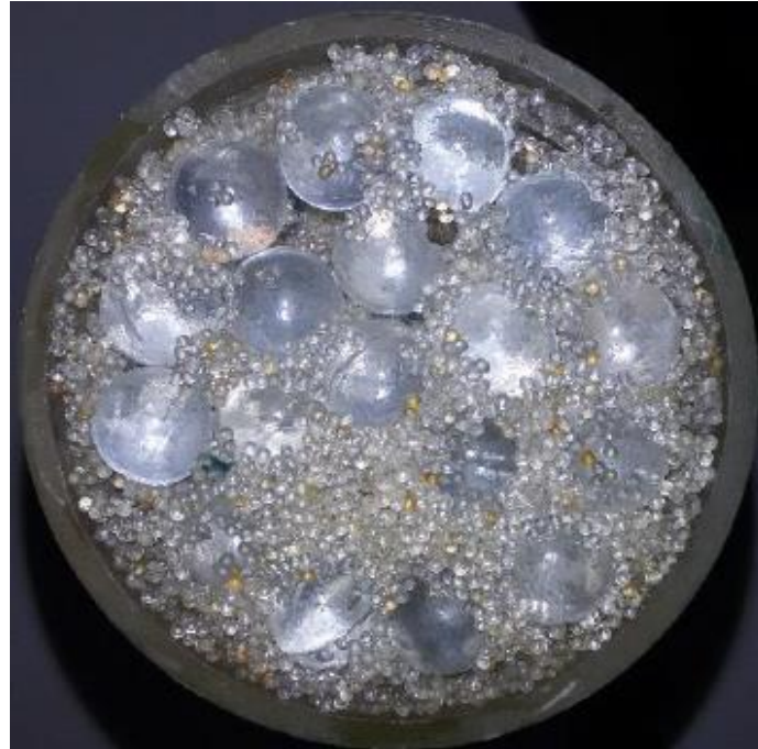
Figure 6.5: Exemple d'une granulométrie binaire obtenue lors du remplissage de la colonne
