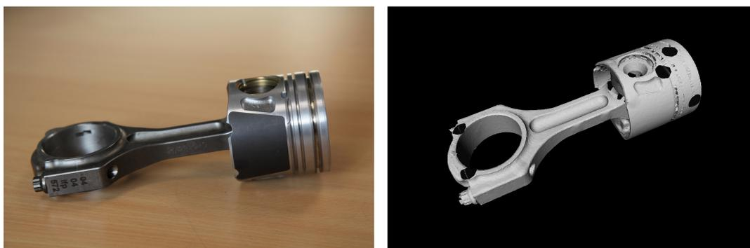
FIGURE 4.24 – Présentation des données d'entrée pour le cas d'étude : à gauche, une photographie de l'assemblage et à droite, le maillage de l'assemblage (les ronds noirs correspondent à des pastilles qui servent de repère lors de l'acquisition des données).
