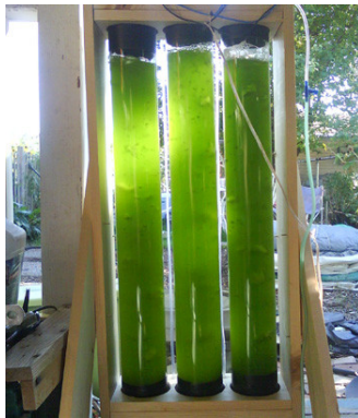
(a) Photobioréacteur « fait main » Source : post du blog www.inventgeek.com
