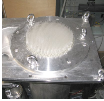
(b) Photo de l'entrée des fibres optiques dans le prototype DiCoFluV
