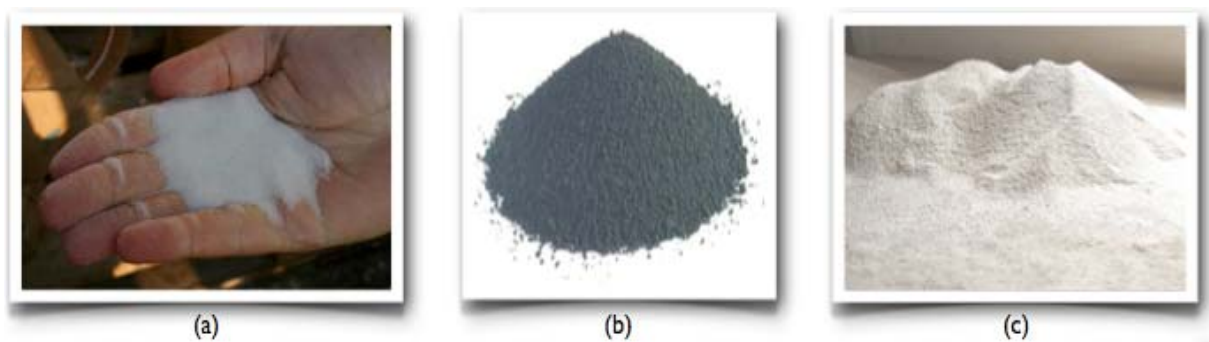
Figure 3 - 4 : Exemples des charges utilisées dans les composites à matrice organique : (a) micro billes de verre, (b) noir de carbone, (c) silice
