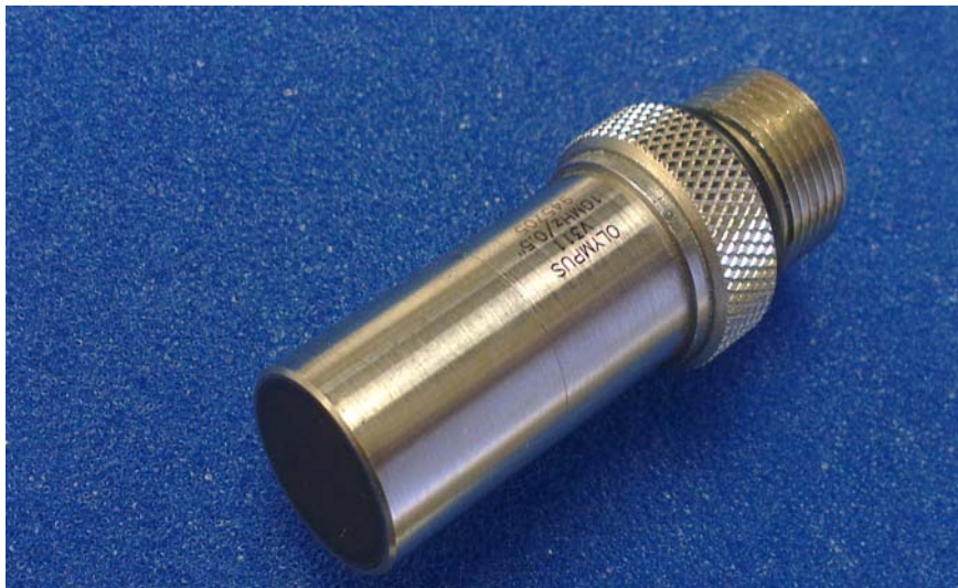
Figure 4 - 7 : Transducteur focalisant Olympus
