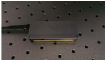
Figure 4 - 1 : Capteur multi éléments – 10 MHz, 128 éléments
