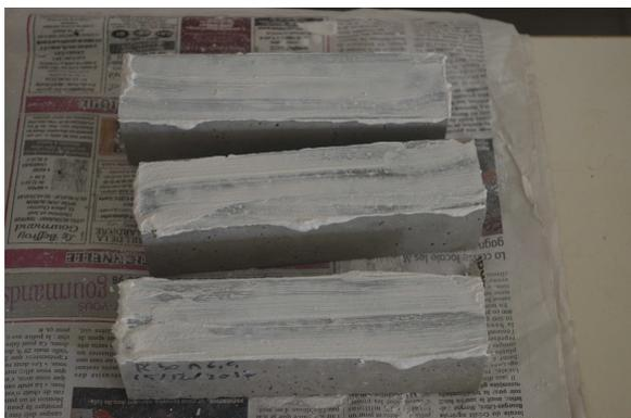
(a) Éprouvettes recouvertes de plâtre
