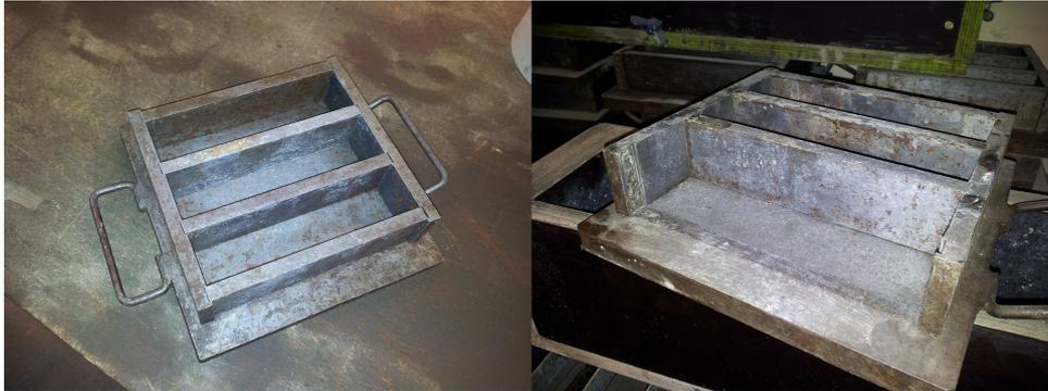
FIGURE 2.1 – Moules ayant servi à la fabrication des éprouvettes
