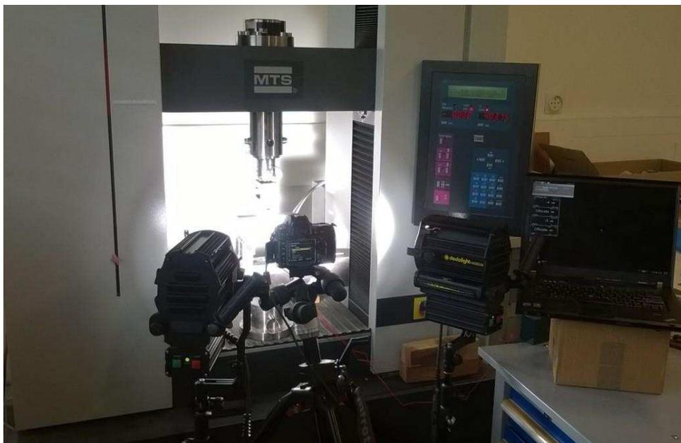
FIGURE 2.12 – Vue de l'essai statique : utilisation du Nikon D700
