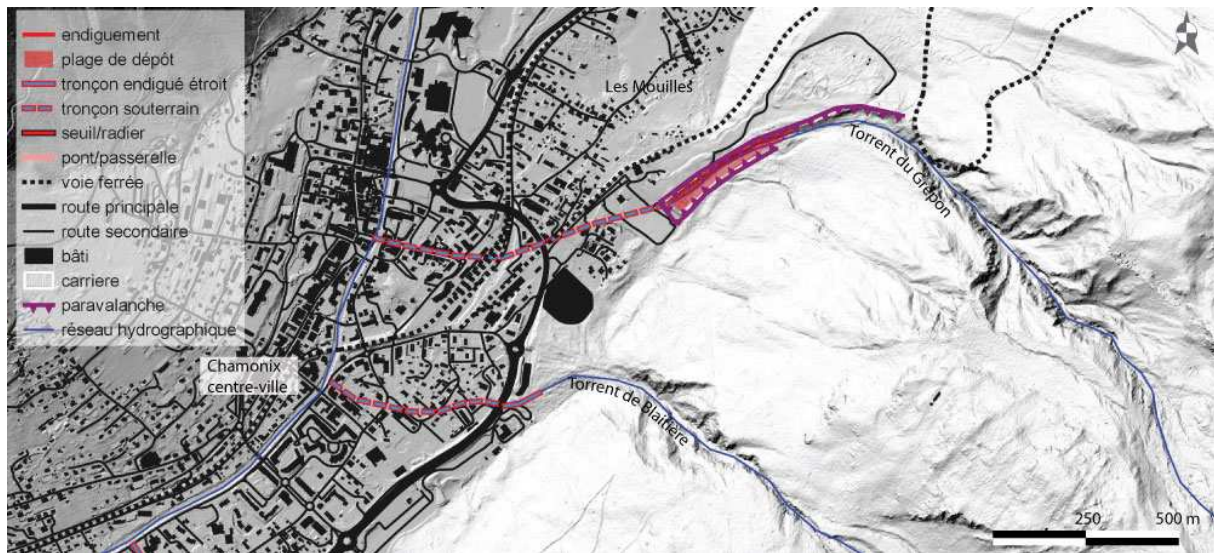
Fig. 2.21 Ouvrages de correction torrentielle et bâti dans les bassins des torrents du Grépon et de Blaitière
