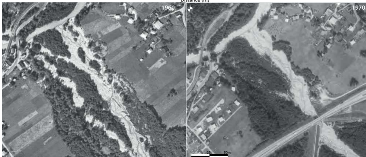
Fig. 6.35 L'incision du torrent de la Creusaz à proximité de sa confluence avec l'Arve (carte Fig. 6.31). (2) le torrent de la Creusaz près de sa confluence en 1960 ; (3) le torrent de la Creusaz près de sa confluence, en 1970, après la construction de la route d'accès au tunnel du Mont-Blanc.
