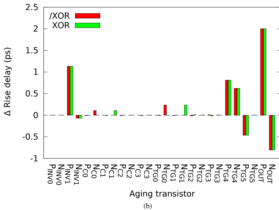
FIGURE 5.9 – Impact du transistor vieilli sur la dégradation du temps a) en descente et b) en montée de la LUT configurée comme des fonctions logiques \overline{XOR} , XOR fonctionnement en mode inverseur.
