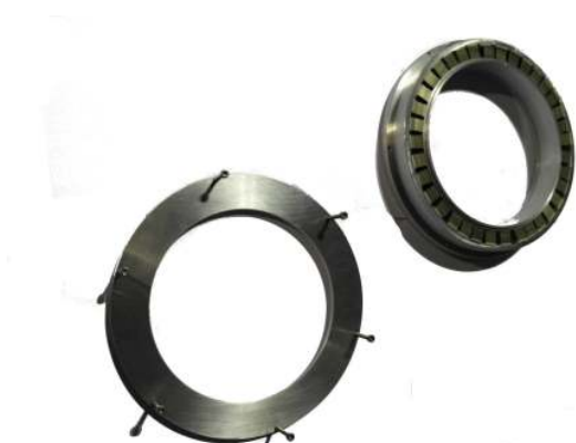
FIGURE 5.5 – Photographie du support à 3 axes des aimants comprenant 36 groupes de 4 aimants.
